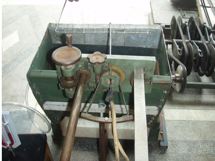
Fig.7.2.1.c Măsurarea câmpului de viteze în secțiunea de refulare a ventilatorului transversal.
