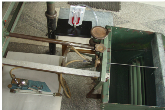
Fig. 7.3.1.3 Folosirea dispozitivului port-sondă pentru poziționarea sondei în punctele de măsurare pentru determinarea câmpului de viteze la gura de refulare a ventilatorului transversal.
