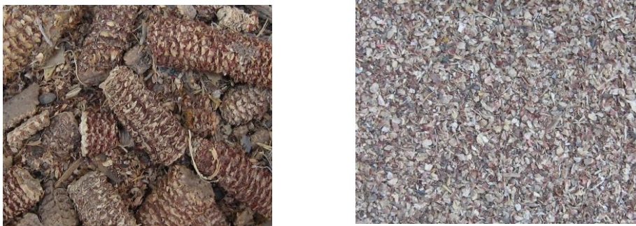
Fig. 5.10 Știuleți de porumb înainte (stânga) și după (dreapta) măcinare
