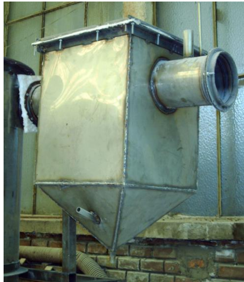
Fig. 4.23 Separatorul de picături
