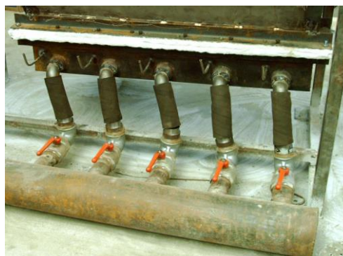
Fig. 4.13 Racordurile prin care aerul de fluidizare pătrunde în focar
