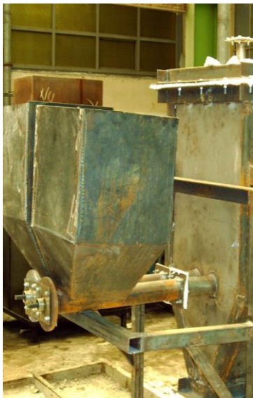
Fig. 4.15 Sistemul de alimentare cu combustibil
