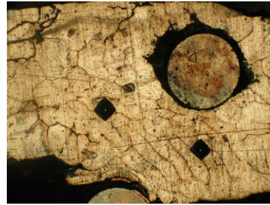
Fig.III.92. Aspectul amprentelor de duritate pentru proba 2 din al doilea material (Si13-S235JR cuprat) supus sudării, MO 100x
