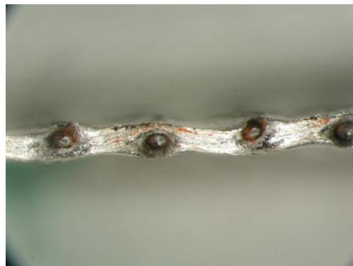
Fig.II.13 Aspect macrostructural al MCM Si13-S235JR cuprat în secțiunea de rupere la tracțiune, 20x
