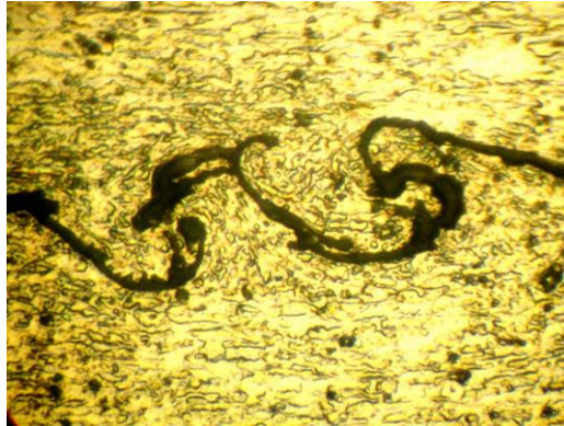
Fig. III.64. Microstructura îmbinării sudate, detaliu –zona B, MO 500x
