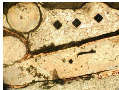
Fig.III.94. Aspectul amprentelor de duritate pentru proba 3 din al doilea material (Si13-S235JR cuprat) supus sudării, MO 100x
