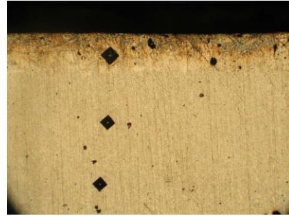
Fig. III.45. Aspectul amprentelor de duritate pentru proba 2, MO 100x
