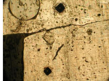
Fig.III.102. Aspectul amprentelor de duritate pentru proba 7.2 fiind supuse sudării o tablă din MCM (Si13-S235JR cuprat) și a doua tablă din Al, MO 100x
