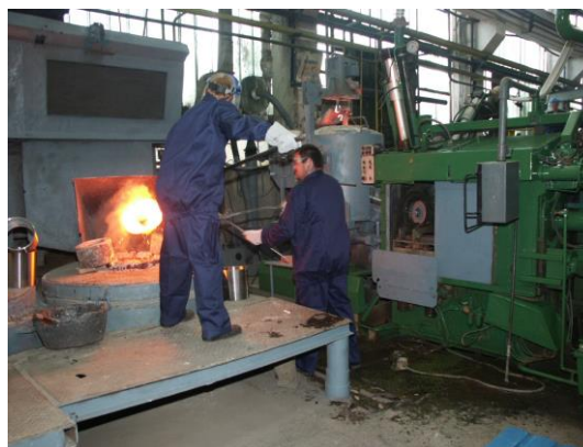
Fig. I.12. Aspecte din timpul aplicării tehnologiei de turnare Viteza de rotație a cochilei în timpul turnării se determină după una din relațiile [114], [117]:
