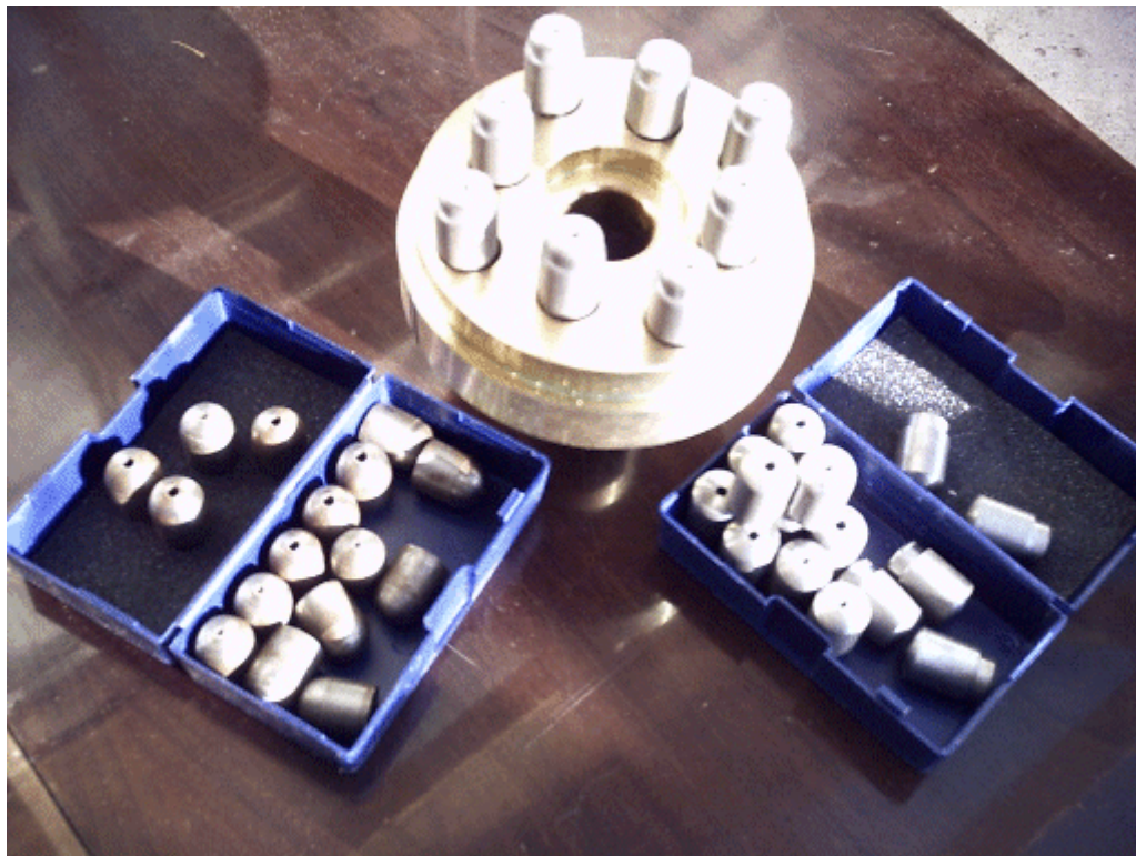
Fig. 7.7. Elemente componente ale cuplajului
