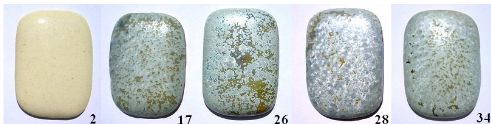
Fig.86. Unele dintre glazurile decorative cristalizate obținute.
