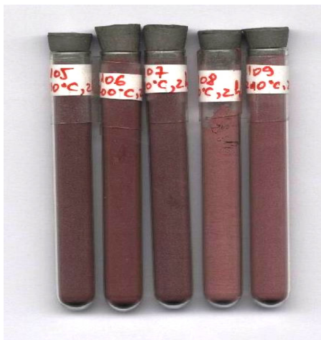
Fig. 49b. Imaginea pigmenților pe bază de sfen de staniu obținuți (P.105, P.106, P.107, P.108, P.109).
