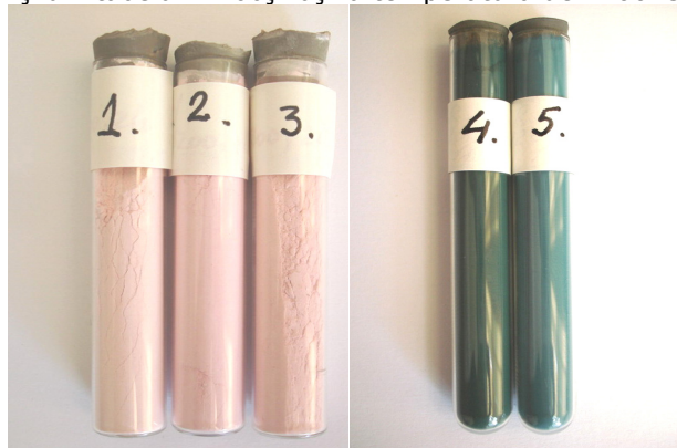
Fig. 54. Pigmenții de culoare roz, respectiv verde-albăstrui cu structură spinelică.
