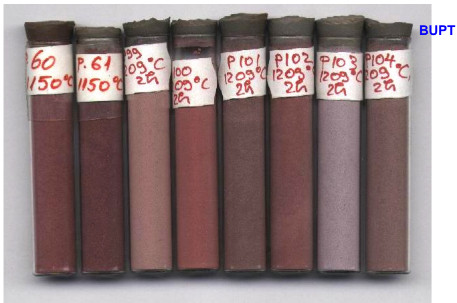
Fig. 49a. Imaginea pigmenților pe bază de sfen de staniu obținuți (P.60, P.61, P.99, P.100, P.101, P.102, P.103, P.104).
