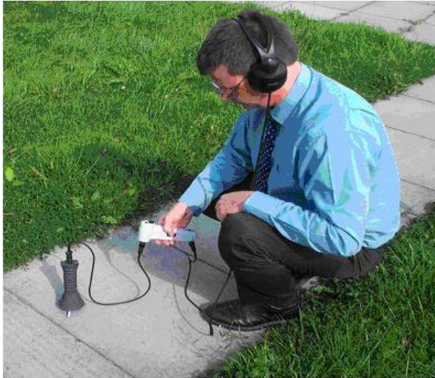
Figura 3. 11 Ascultarea suprafeței solului pe timp de zi
