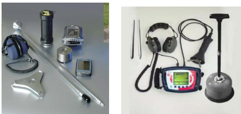
Figura 3. 15 Combinații între loggere, corelatoare și echipamente specializate
