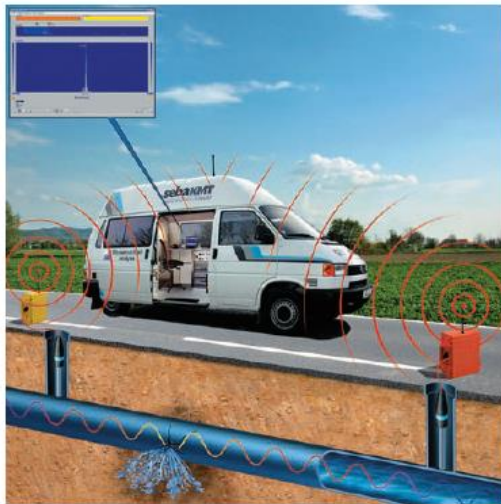
Figura 3. 30 Autolaborator specializat pentru detectare pierderi
