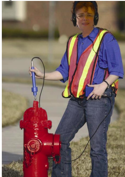
Figura 3. 25 Ascultarea unui hidrant subteran
