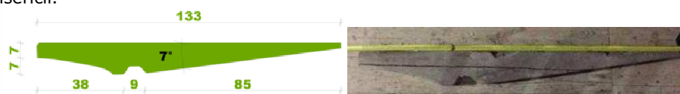
Fig. 72 - vechiul aruncător găsit în cadrul șarpantei. Original, Foto echipa Biserici Înlemnite 2017
