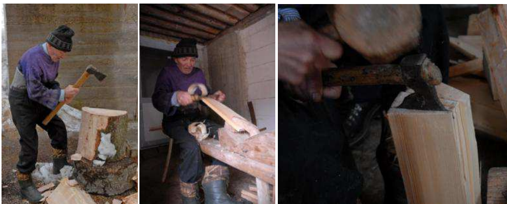
Fig. 23 – Imagini din timpul prelucrării draniței. Foto Alexandru Buftea, mai.2018
