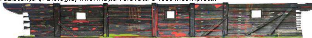
Fig. 38 – Suprapunerea tuturor informațiilor relevate pentru fațada nordică. Echipa Biserici Înlemnite, 2015-2016
