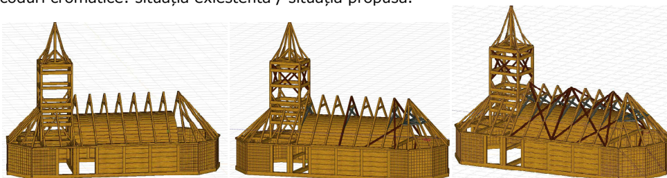
Fig. 58 – Piese din cadrul modelării 3D: solicitarea elementelor structurii exprimate grafic prin coduri cromatice: situația existentă / situația propusă.
