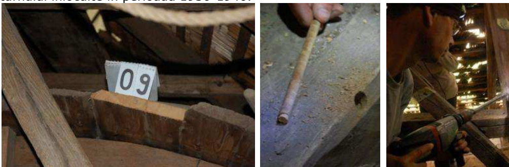
Fig. 43 – Imagini din timpul preluării probelor: probă obținută prin secționare / probă obținută prin frezare și extragere / imagine în timpul frezării . Foto Echipa Biserici Înlemnite
