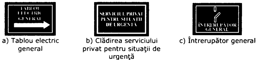
Figura 3.27 Indicatoare de informare
