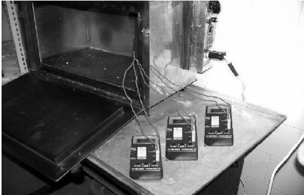
Figura 5.13 Măsurarea experimentală a temperaturilor în peretele pupinelului
