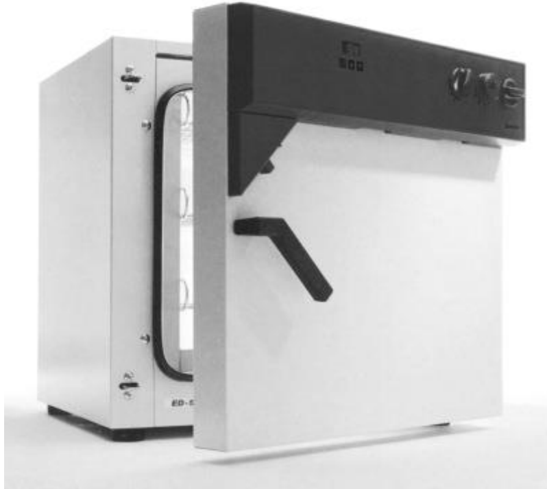
Figura 2.14 Sterilizatoare cu aer cald uscat de 53 l
