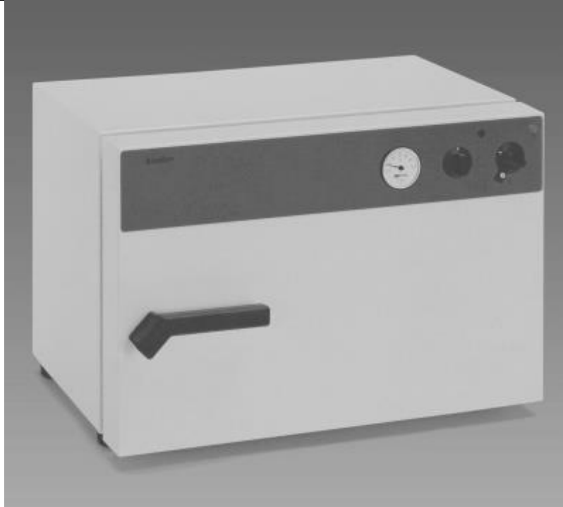
Figura 2.13 Sterilizatoare cu aer cald uscat de 28 l
