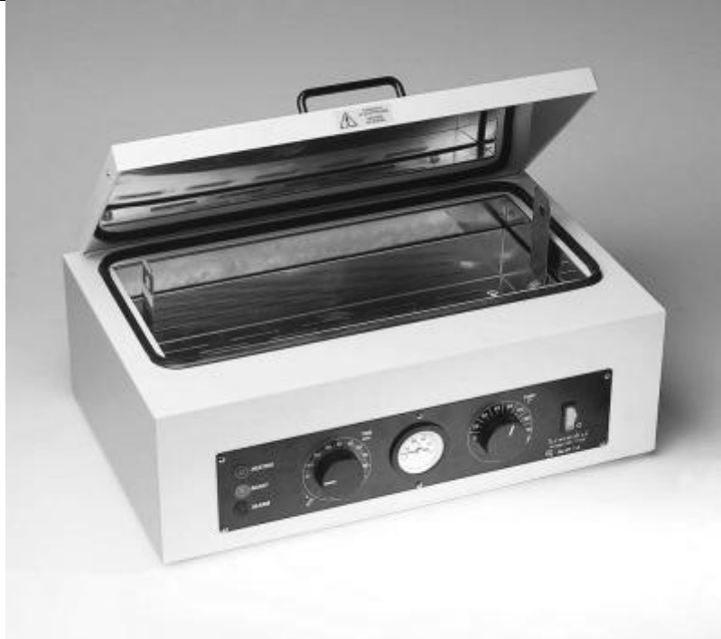
Figura 2.11 Sterilizatoare cu aer cald uscat de 6 l
