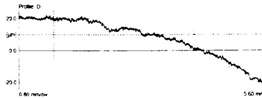
Fig 4.47 a Ti anodizat 60 V profil D
