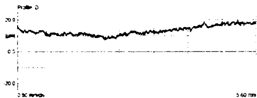
Fig 4.48 a Ti anodizat 80 V profil D
