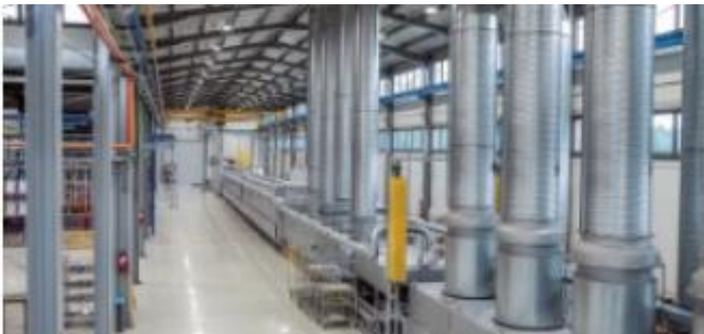
Figura 17 Cuptor de brazare dedicat plăcilor de răcire pentru baterii
