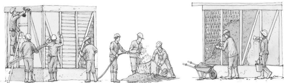
Fig. 45. Metoda de construcție a paiantei, imagine preluată după: © Laetitia Fontaine și Romain Anger, „Bâtir en terre: du grain de sable à l'architecture”, pag.78-79;
