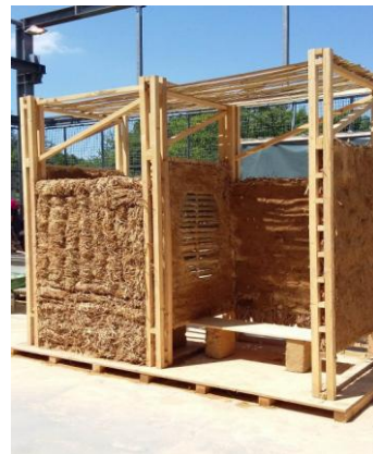
Fig. 209. Experimente privind tehnica pământului compactat, modul în care se adaugă lianți în straturile intermediare (în acest caz straturi de mortar), se modifică rezistența la compresiune, sursă: E.R.Florescu;
