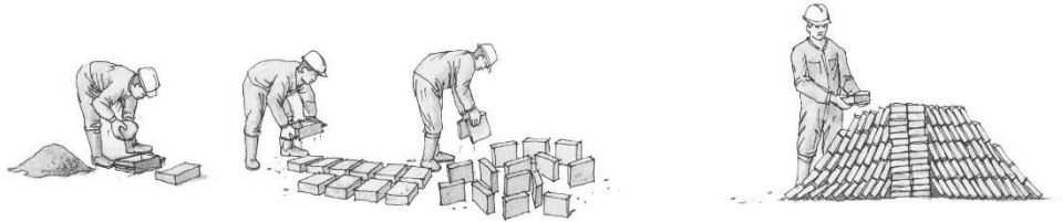
Fig. 38. Metoda de construcție a cărămizilor compactate, imagine preluată după: © Laetitia Fontaine și Romain Anger, „Bâtir en terre: du grain de sable à l'architecture”, pag.42-43;
