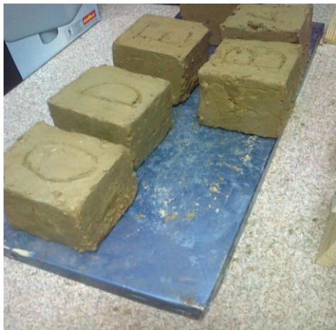
Fig. 173. Epruvetele realizate folosind pământ local în diferite stadii de uscare - punerea în formă, sursă: E.R.Florescu; Fig. 174. Epruvetele realizate folosind pământ local în diferite stadii de uscare - conformarea în funcție de forma matriței, sursă: E.R.Florescu; Fig. 175. Epruvetele realizate folosind pământ local în diferite stadii de uscare - îndepărtarea matriței după 3 săptămâni, sursă: E.R.Florescu; Fig. 176. Epruvetele realizate folosind pământ local în diferite stadii de uscare - inspectarea diverselor deformații rezultate în urma procesului de uscare, sursă: E.R.Florescu;
