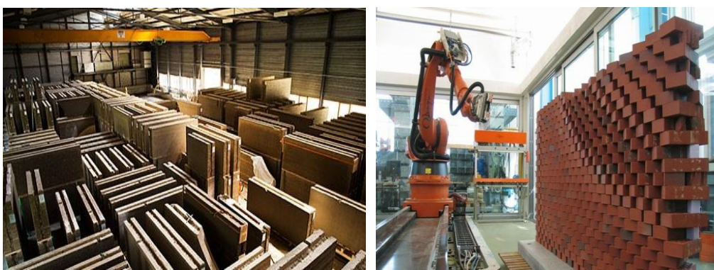
Fig. 67. Pereți realizați din elemente prefabricate, sursă: © Lehm Ton Erde Baukunst GmbH; Fig. 68. Robot semiautomat, sursă: © https://www.ireviews.com/news/2017/04/05/sam100-semi-automated-mason , ultima accesare:01.2021;
