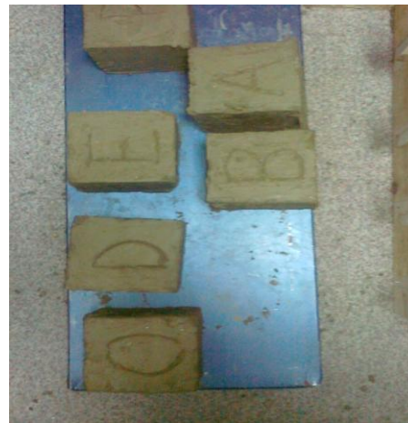
Fig. 173. Epruvetele realizate folosind pământ local în diferite stadii de uscare - punerea în formă, sursă: E.R.Florescu; Fig. 174. Epruvetele realizate folosind pământ local în diferite stadii de uscare - conformarea în funcție de forma matriței, sursă: E.R.Florescu; Fig. 175. Epruvetele realizate folosind pământ local în diferite stadii de uscare - îndepărtarea matriței după 3 săptămâni, sursă: E.R.Florescu; Fig. 176. Epruvetele realizate folosind pământ local în diferite stadii de uscare - inspectarea diverselor deformații rezultate în urma procesului de uscare, sursă: E.R.Florescu;
