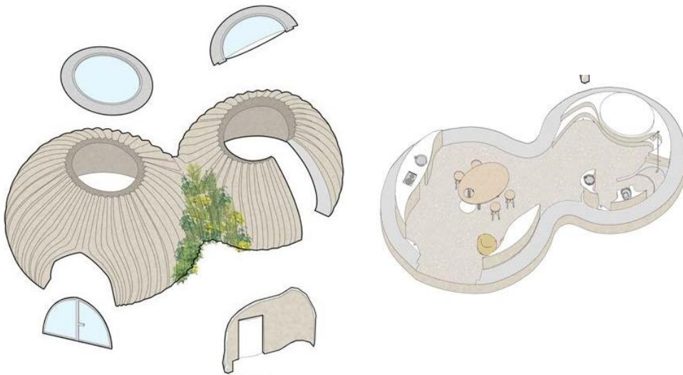
Fig. 76. Axonometrie ilustrând dispunerea funcțională a unui modul Tecla, preluare după: © https://www.3dwasp.com/en/3d-printed-house-tecla/ , ultima accesare: 04.2021;
