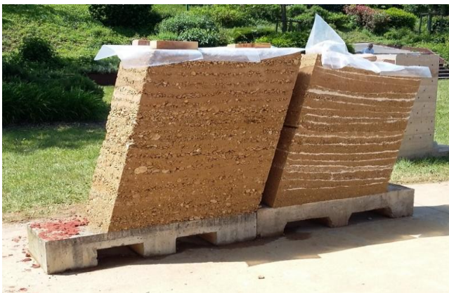
Fig. 209. Experimente privind tehnica pământului compactat, modul în care se adaugă lianți în straturile intermediare (în acest caz straturi de mortar), se modifică rezistența la compresiune, sursă: E.R.Florescu;
