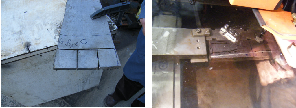
Fig. 6.15 Realizarea epruvetelor pentru încercările mecanice (debitarea din corpul paletelor, debitarea blocurilor de epruvete prin electroeroziune cu fir pe profil)
