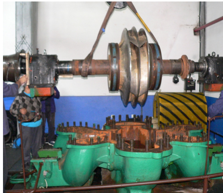
Fig. 4.7 Imagine de ansamblu privind montarea arborelui împreună cu rotorul și lagărele în carcasa pompei
