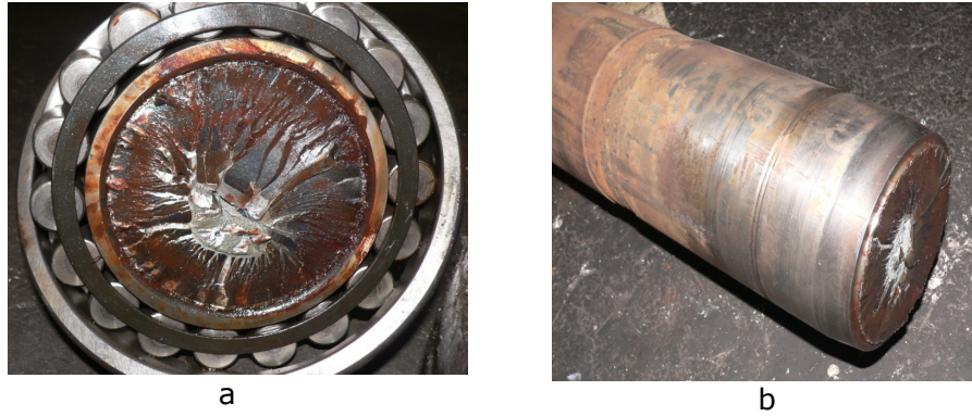
Fig. 4.8 Aspectul zonei de rupere a arborelui
