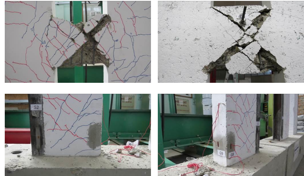
Fig. 5.20 Modul de cedare al peretelui compozit CSRCW-21-CO
