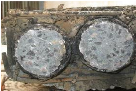
Fig. 2.50 Secțiunea transversală, curbele înfășurătoare respectiv nivelul degradărilor atins la nivelul țevilor metalice [71]
