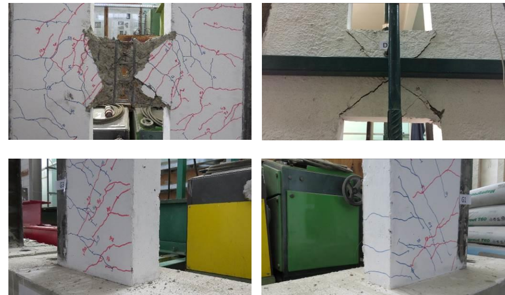
Fig. 5.19 Modul de cedare al peretelui compozit - CSRCW-20-CO
