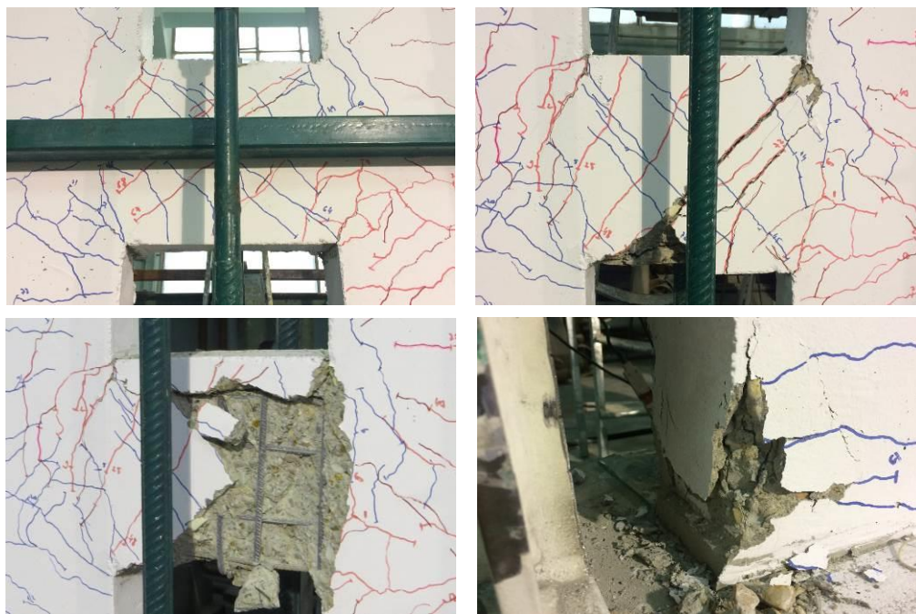
Fig. 4.24 Modul de cedare a elementului RCW-23-CO
