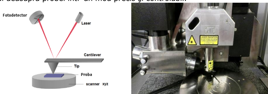
Figura 2.9. Schema și imaginea microscopului de forță atomică (AFM)
