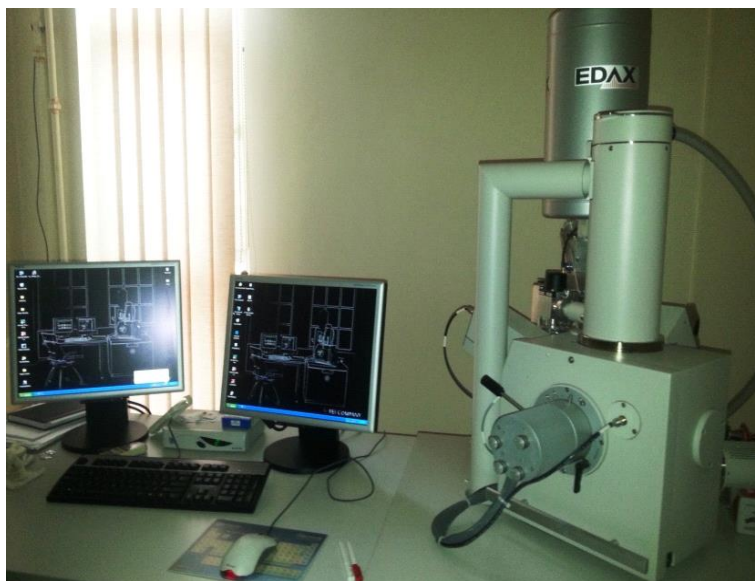
Figura 2.3. Microscopului Electronic cu Baleiaj (SEM)- Inspect S (FEI Company) + Edax
