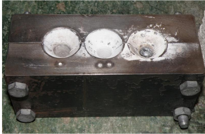
Fig. 4.8 Forma de turnare a aliajului primar
