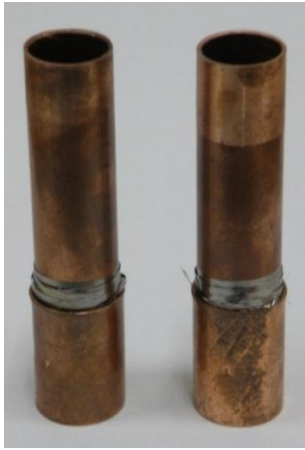
a) așezarea aliajului de lipireși montarea manșonului
