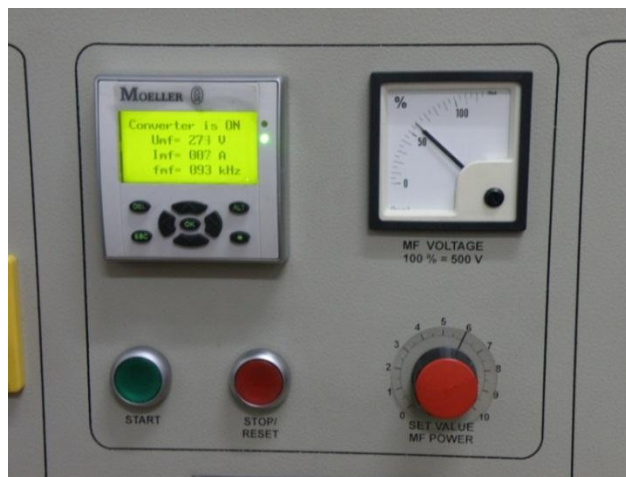
Fig. 5.41 Detaliu cu panoul de setare și afișare a parametrilor curentului de inducție
