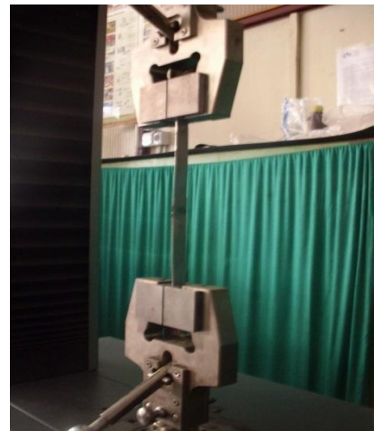
Fig. 5.18 Desfășurarea încercării la forfecare
