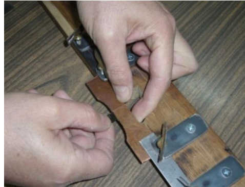
b) Prinderea platbenzilor în dispozitivul de fixare și plasarea aliajului de lipire
