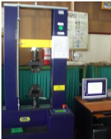
Fig. 5.18 Desfășurarea încercării la forfecare
