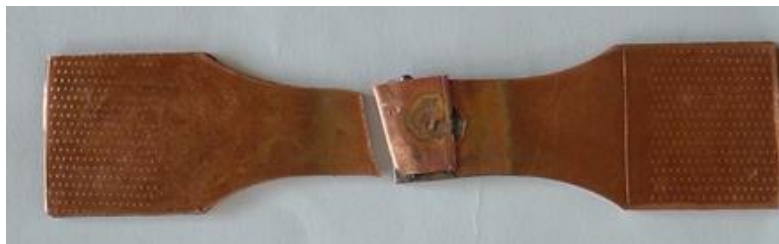
Fig. 5.20 Proba încercată la forfecare
