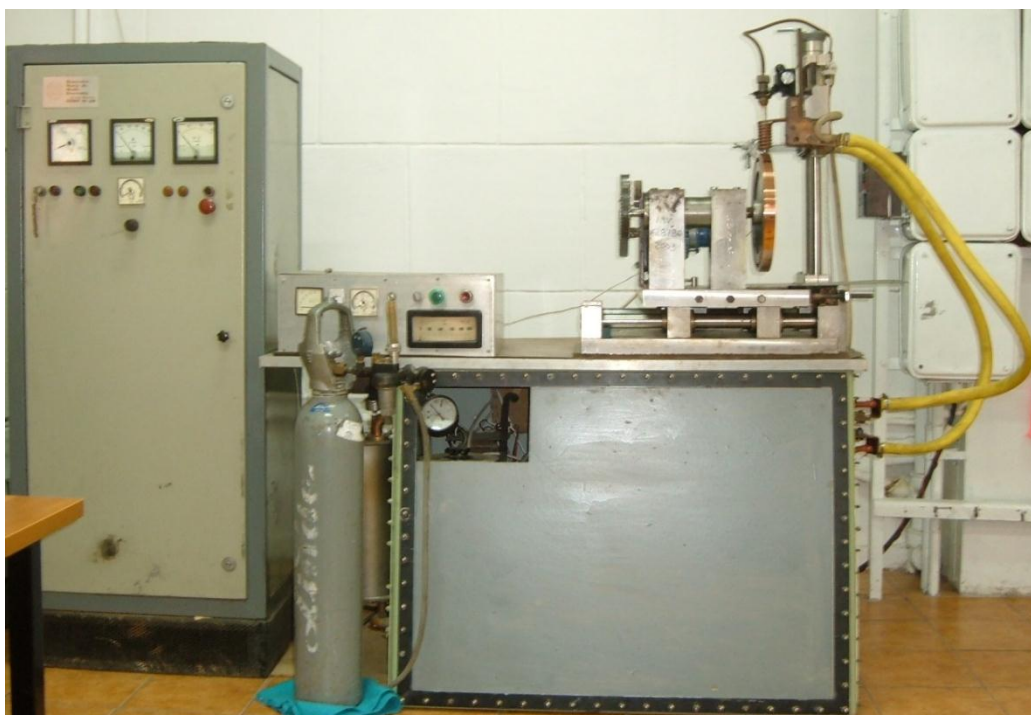
Fig. 4.10 Instalație de elaborare a aliajelor amorphe prin metoda melt-spinning
