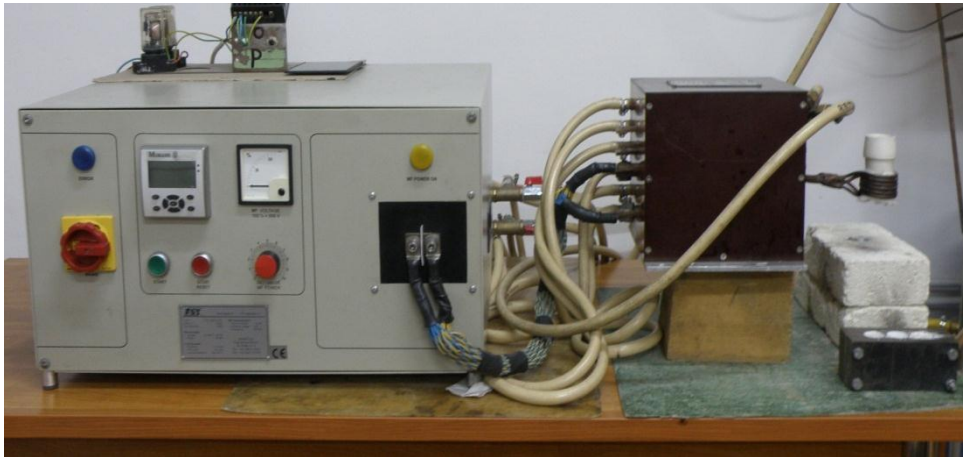
Fig. 4.6 Instalația cu încălzire prin inducție pentru elaborarea aliajului primar
