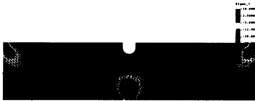
Figura 3.38. Variația tensiunii \sigma_y în proba cu creștătură U
