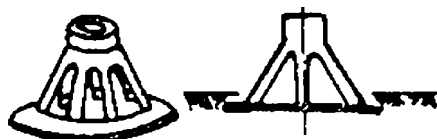
Fundație din hiperboloizi cu goluri și inel de rezemare (fosta U.R.S.S.).
