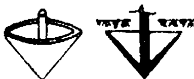
Fundație izolată din placă subțire conică întoarsă (Ungaria).
