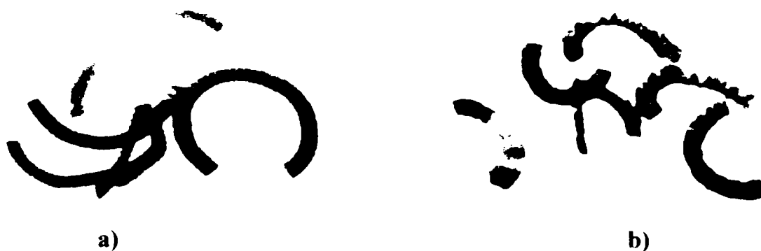
Fig. 6.16. Așchii rezultate la prelucrarea oțelului Armco: a) la aschiera obișnuită; b) la aschiera cu vibrații.
