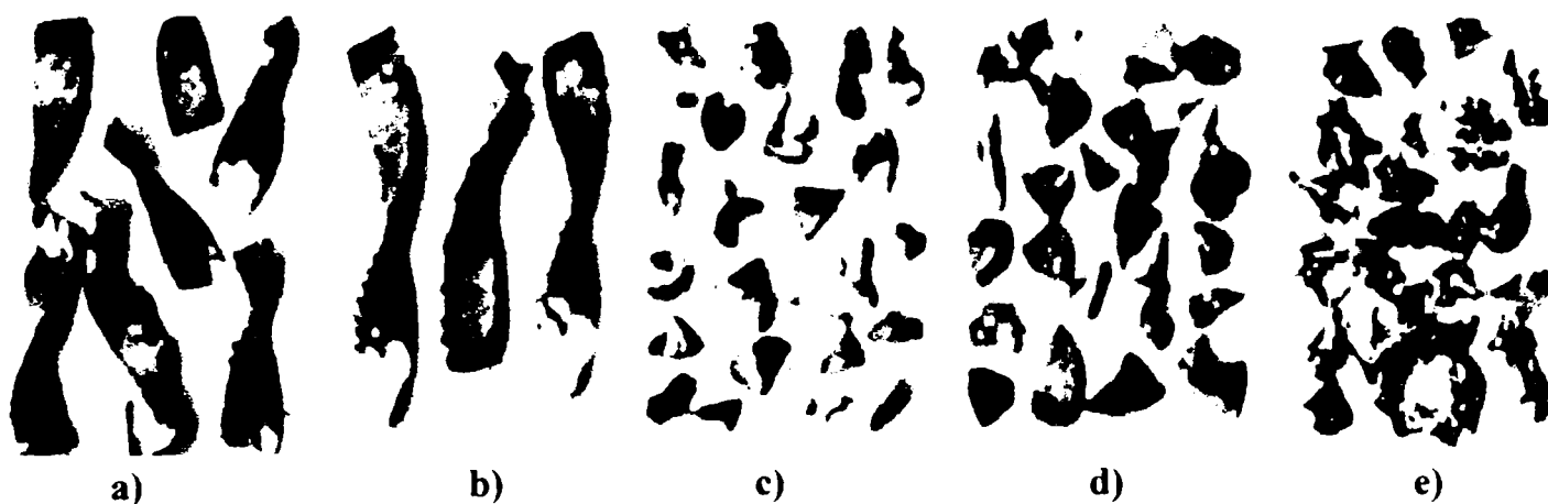
Fig. 9.33. Tipuri de așchii rezultate la așchiera vibropercutantă a Cu OFHC cu viteză de avans de 6[mm/min] și turații de: a) n=430 , b) n=559 , c) n=619 , d) n=686 și e) n=771 [rot/min].
