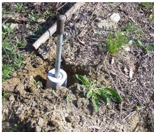
Fig. 6.14. Borna FENO utilizată pentru materializarea punctelor din rețea
