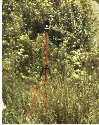
Fig. 6.40. Imaginea țintei pe baston utilizată la înregistrare
