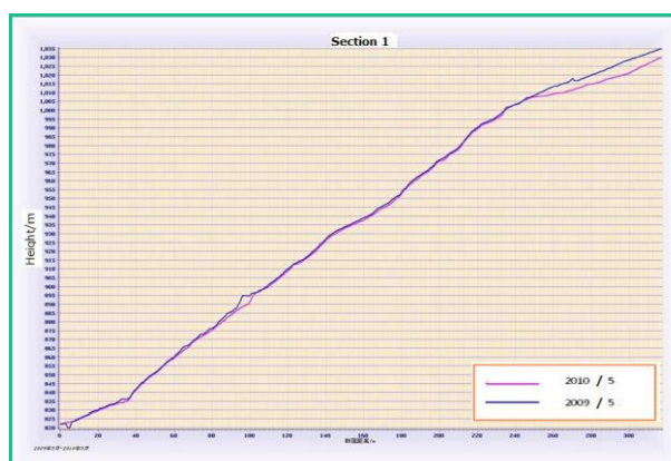
Fig. 5.38. Crearea unei secțiuni longitudinale prin cele 2 suprafețe scanate
