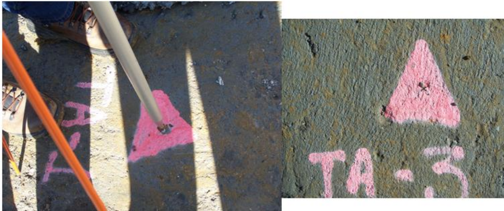
Fig. 6.82. Punctele TA 1, TA 3 folosite pentru ținte din stația 3 de scanare
