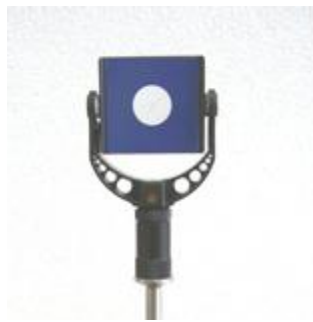
Fig. 6.33. Ținta de 3" folosită la scanare
