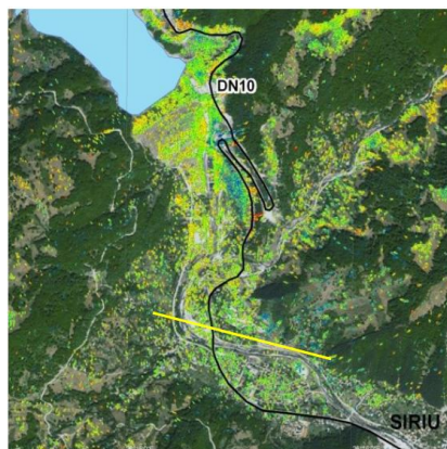
Fig. 5.67. Harta deformațiilor în zona barajului și a satului Siriu [104]
