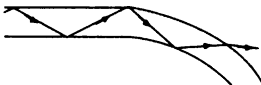
Figura 1.12 Atenuarea luminii funcție de gradul de îndoire a fibrei optice
