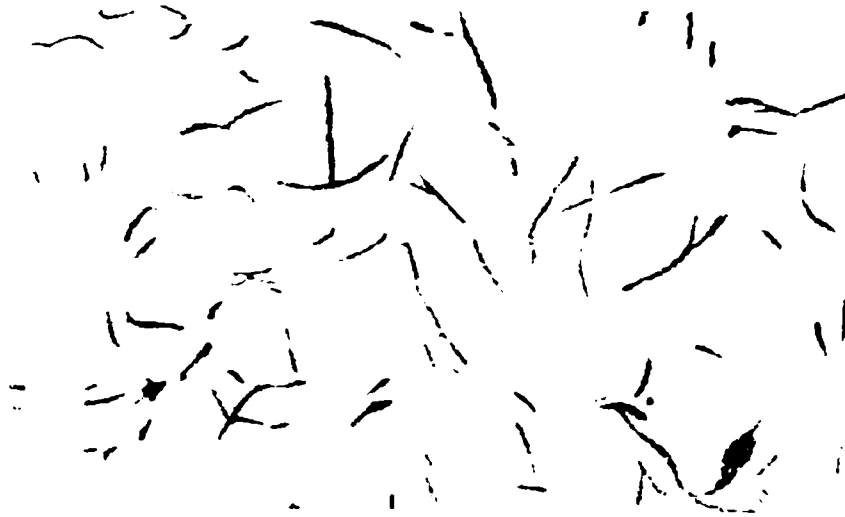
Fig.A.9.5.26. Microstructură cu lungimea lamelelor în fontă cu grafit lamelar. punctaj = 4, mărire x100.
