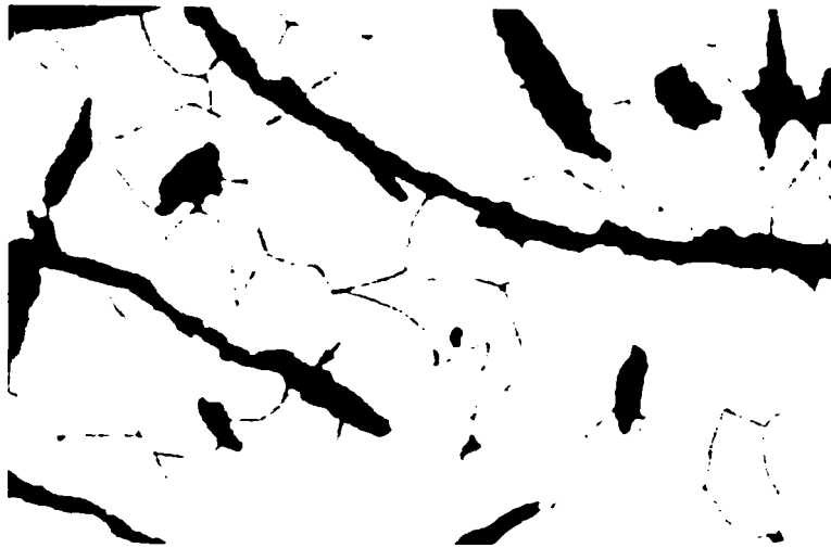
Fig.A.9.1.4. Fontă cenușie feritică. mărire x500.
