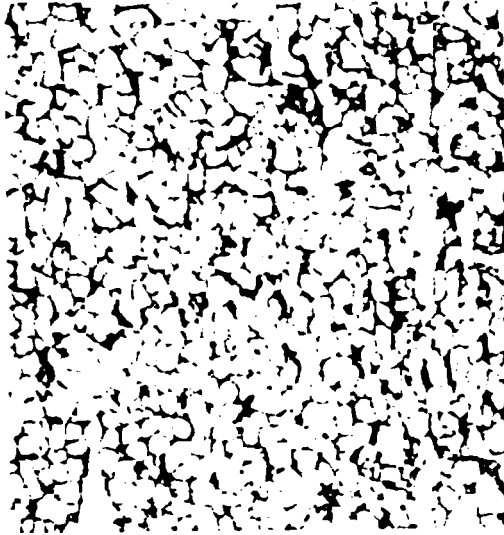
Fig.A.9.5.1. Oțel până la 0.15%C. structură ferito-perlitică în șiruri, mărire x100, punctaj = 0.
