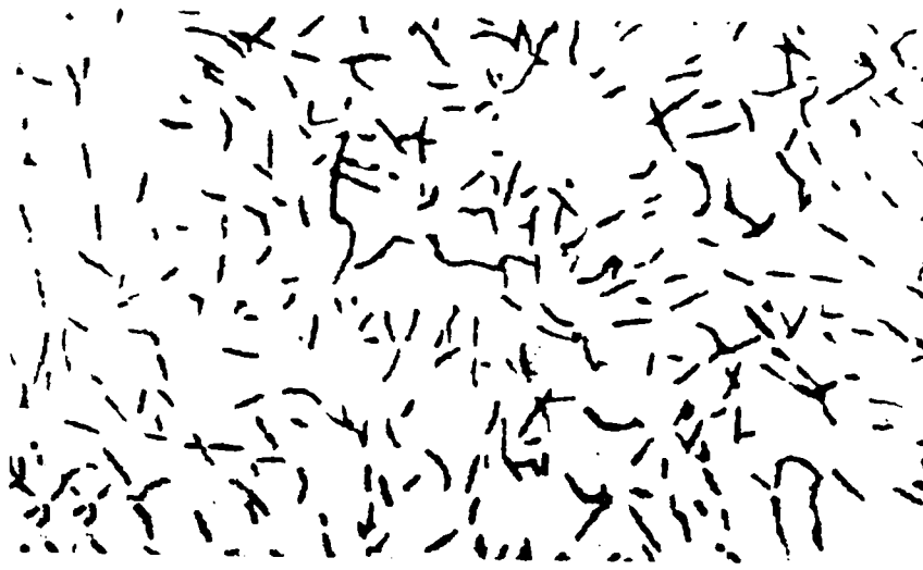
Fig.A.9.5.25. Microstructură cu lungimea lamelelor în fontă cu grafit lamelar. punctaj = 3, mărire x100.
