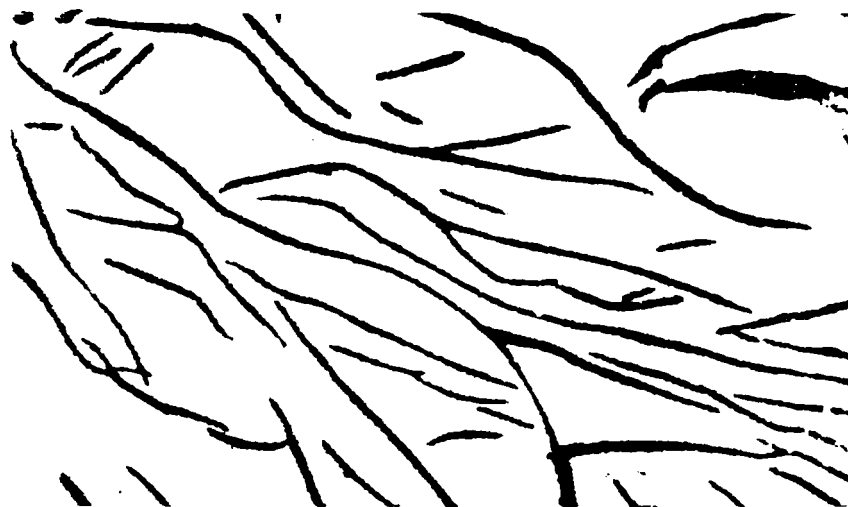
Fig.A.9.5.28. Microstructură cu lungimea lamelelor în fontă cu grafit lamelar. punctaj = 6. mărire x100.
