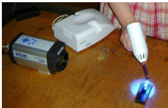
Figura 3.9 Înregistrarea procesului de fotopolimerizare cu camera termografică
