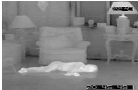
Figura 2.26 Imagine în IR în timpul unui incendiu [W1] ce indică o persoană aflată în pericol
