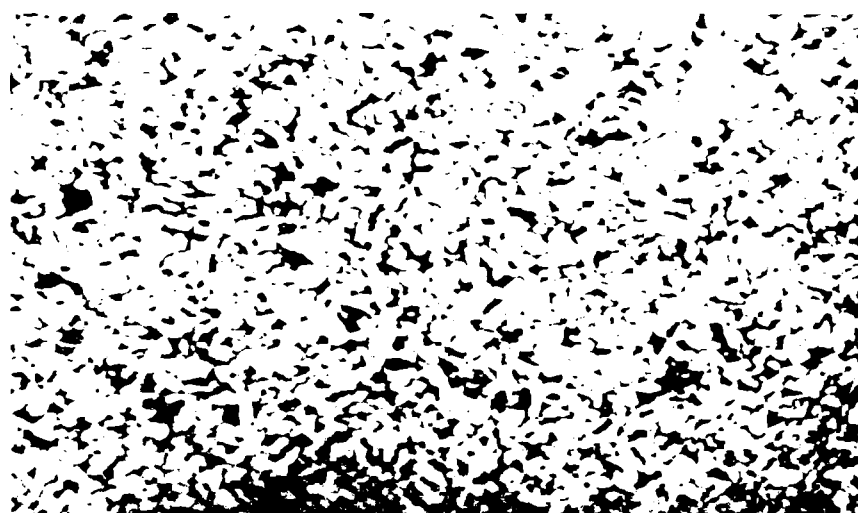
Fig.2.23. Structura țevii prelevată din focarul cazanului de abur – oțel OLT 35K
