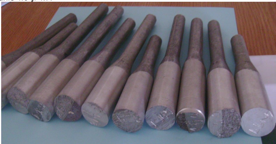
Figura 4.6 Epruvete netratate termic rupte după încercarea la tracțiune
