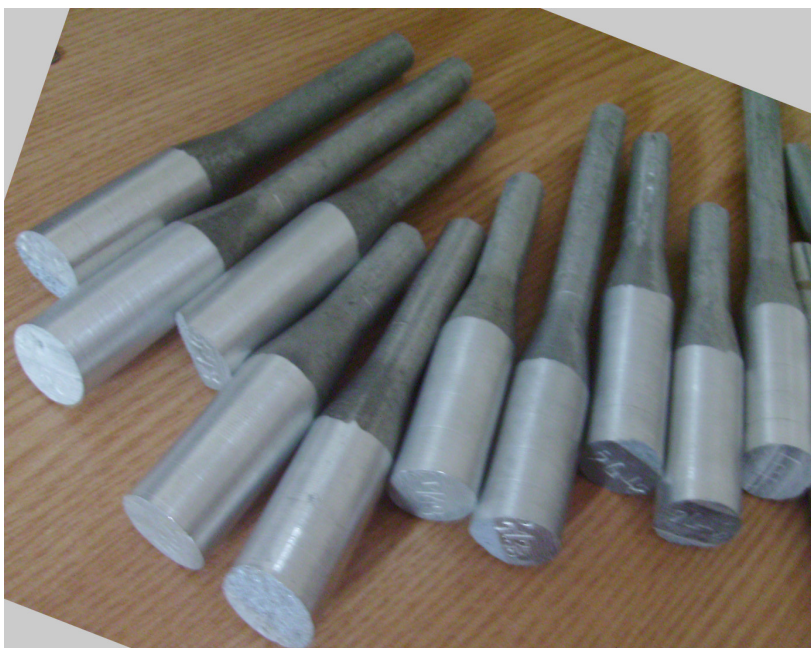
Figura 4.7 Epruvete tratate termic rupte după încercarea la tracțiune
