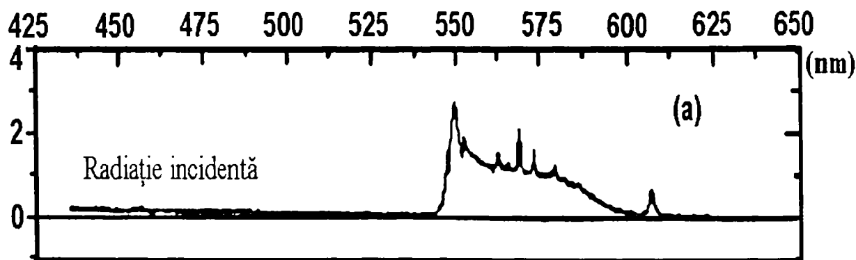
Fig. 3.4. Spectrul de emisie a radiației de excitație
