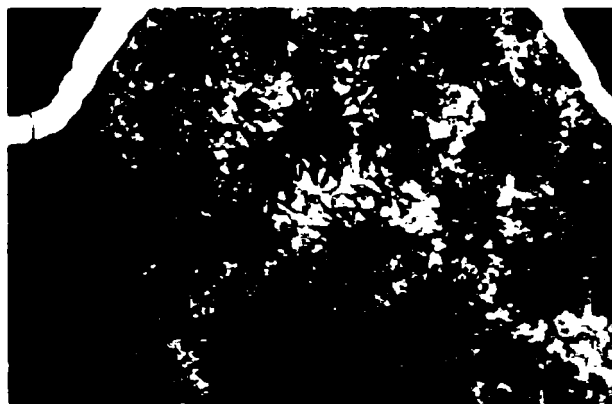
Figura 6.22 Aspect suprafață segment de ungere cromat după 500 ore funcționare (fabricație de serie), 100:1, atac nital
