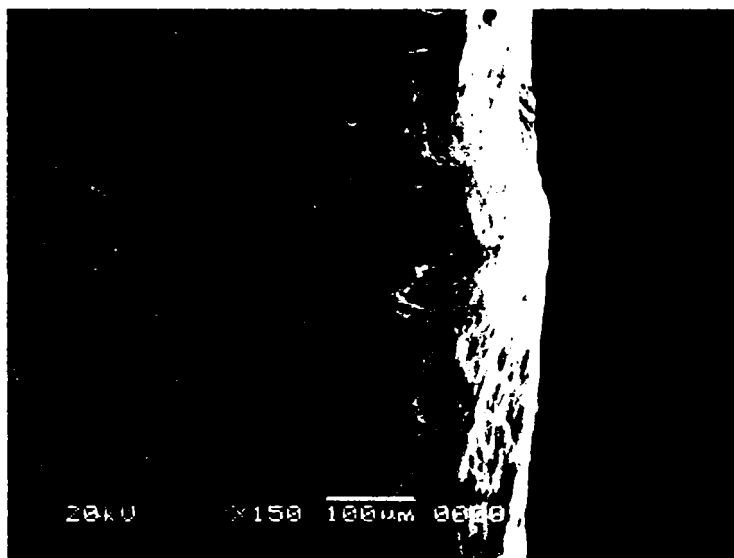
Figura 6.64 Strat superficial deformat (MEB)
