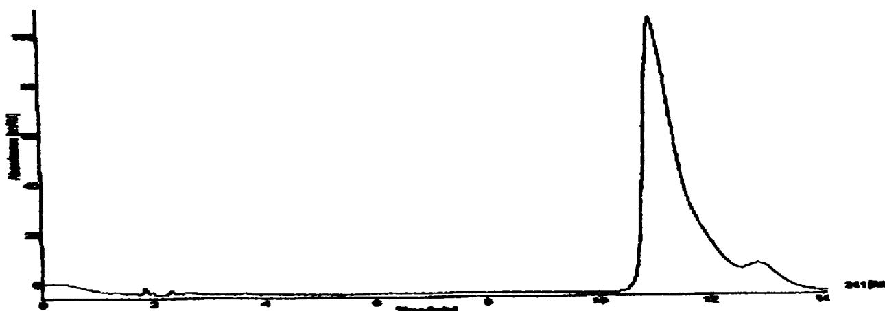
Fig.5.11: Cromatogramele acidului abietic obținute prin tehnica de HPLC cu fază inversă; a) acid abietic izolat din colofoniu și purificat prin recristalizări repetate din acid acetic; b) acid abietic separat din sarea sa cu (-)-chinină
