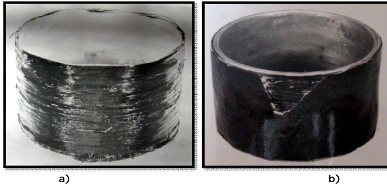
a) Figura 1.40. Ecrane magnetice obținute prin înfășurare: a) pe suport de hârtie și b) pe suport metalic (preluată din [31])
