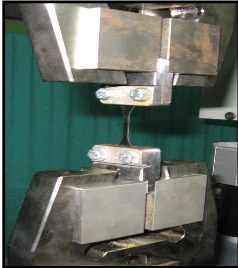
Figura 4.28. Prinderea epruvetei în bacurile mașinii de încercat prin intermediul dispozitivului
