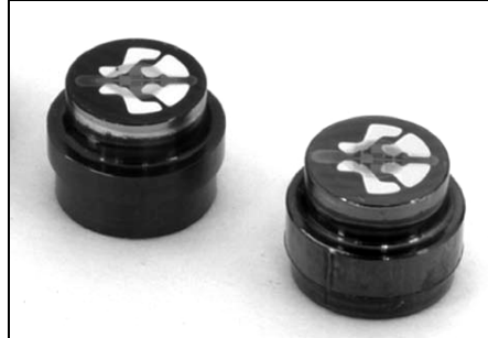
Figura 1.44. Diafragme obținute din aliajele amorfe masive pe bază de Zr (preluată din [99])
