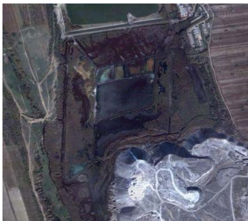
Fig.2.4. Iazul decantor a șlamului de furnal și convertizor rezultat pe platforma industrială a combinatului S.C. ArcelorMittal Galati S.A. [1, 2]
