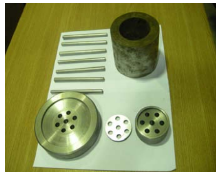
Fig.4.8.A. Dispozitive folosite pentru producerea brichetelor multicave și tubulare cu cavități: a) matriță pentru brichete tubulare cu cavități; b) matriță pentru brichete multicave
