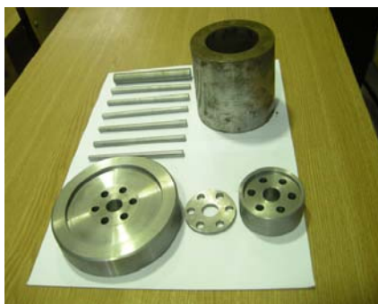
Fig.4.8.A. Dispozitive folosite pentru producerea brichetelor multicave și tubulare cu cavități: a) matriță pentru brichete tubulare cu cavități; b) matriță pentru brichete multicave
