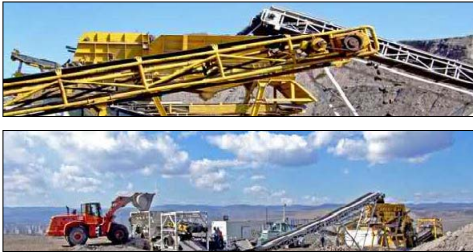
Fig.2.38. Instalația de concasare – deferitizare - sortare, tip UTN 300 COBRA ED 7015 [1]
