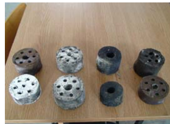
Fig.7.1.A. Brichete introduse în cuptorul de calcinare: a) înainte procesului de reducere; b) după procesul de reducere
