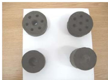
Fig.7.1.A. Brichete introduse în cuptorul de calcinare: a) înainte procesului de reducere; b) după procesul de reducere
