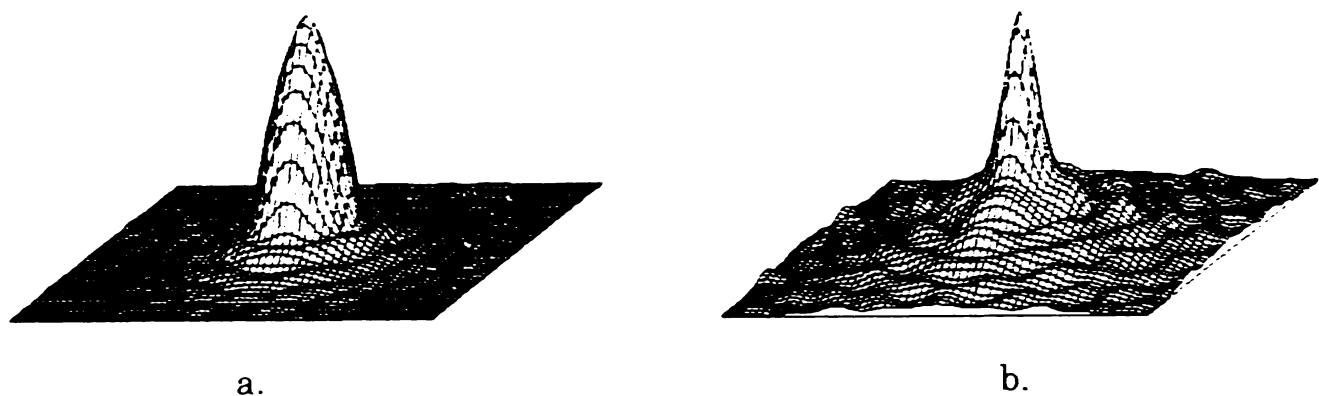
Fig. 3.14 Influența aberației de sfericitate asupra imaginii punctului a. fără defocusare, b. cu defocusare
