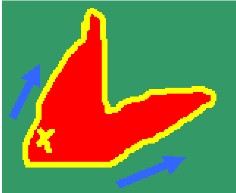
Fig.4.12-Dezvoltarea incendiului în condiții de vânt puternic, ușor variabil
