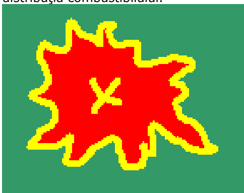
Fig.4.9-Dezvoltarea incendiului în condiții de lipsă de vânt și pe teren orizontal și distribuție uniformă a combustibilului
