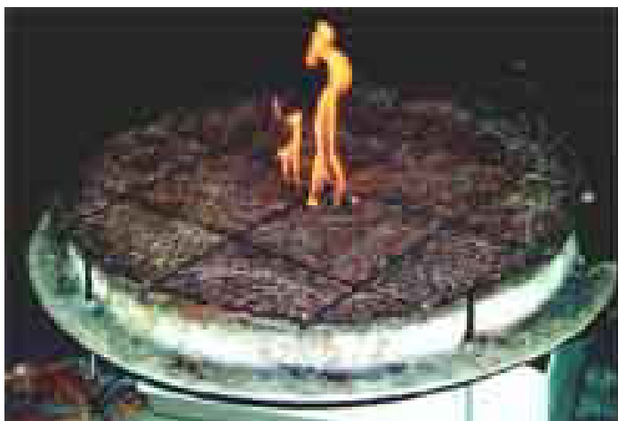
Fig.4.3-Determinarea inflamabilității unei litiere: măsurarea vitezei de propagare a focului și pierderii greutății litierei (foto : Cemagref – C Iampin)
