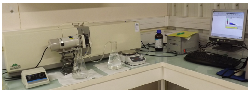
Figura 5.2. Granulometru Malvern Mastersizer 2000
