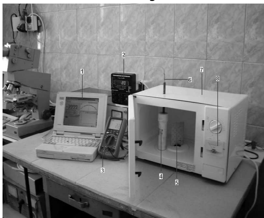
Fig. 3.7. Instalație de obținere a nanocristalelor prin metoda solvotermală în câmp de microunde
