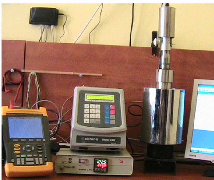
Fig. 3.6. Instalație experimentală de obținere a nanoparticulelor prin metoda solvotermală asistată ultrasonic cu generator Cole-Palmer EW-04711-45, pe frecvența de 20 kHz împreună cu sistemele de achiziție și control
