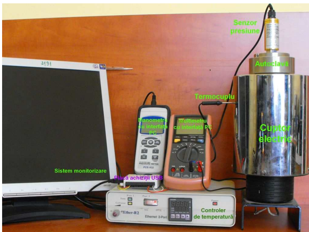
Fig. 3.2. Instalație experimentală de obținere a nanoparticulelor prin metoda solvotermală clasică împreună cu sistemele de achiziție și control.
