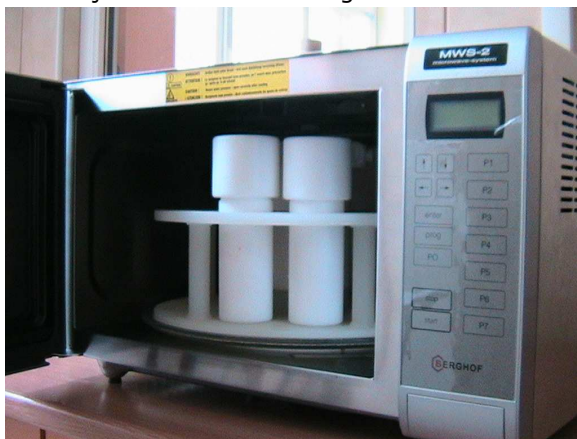
Fig. 3.8. Cuptor cu microunde de laborator interfațat PC (BERGHOF) cu până la șase autoclave.
