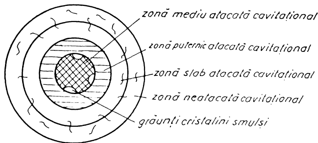
Fig.6.5 Aspectul suprafetei probei erodata cavitacional
