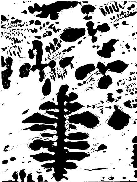
Fig.3.13 Microstructura aliajului 5N (MO 250x)
