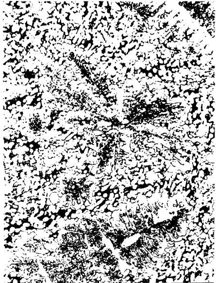
Fig.3.16 Microstructura aliajului 5R (MO 250x)
