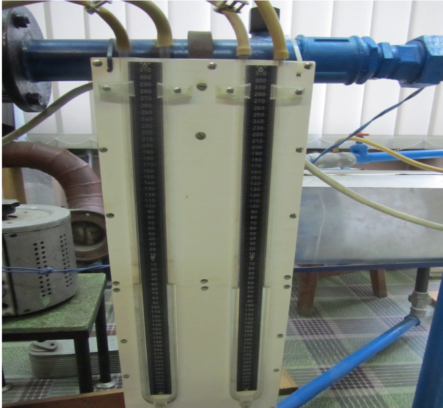
Fig.3.7. Panouri tuburi „U”
