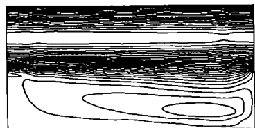
Figura 6.5.24 Liniile de curent pentru Re = 1000 \quad H^* = 0,5 \quad P^* = 2
