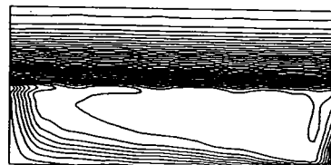
Figura 6.5.96 Izotermele pentru Re = 1000 H^* = 0,5 P^* = 2 Pr = 7
