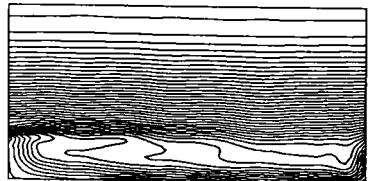
Figura 6.5.78 Izotermele pentru Re = 1000 H^* = 0,25 P^* = 2 Pr = 7
