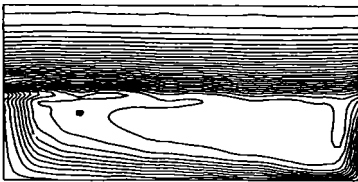
Figura 6.5.93 Izotermele pentru Re = 500 H^* = 0,5 P^* = 2 Pr = 7
