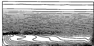
Figura 6.5.77 Izotermele pentru Re = 1000 H^* = 0,25 P^* = 2 Pr = 5
