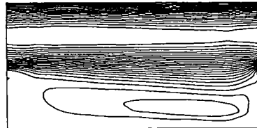
Figura 6.5.23 Liniile de curent pentru Re = 500 \quad H^* = 0,5 \quad P^* = 2
