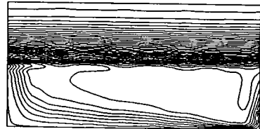
Figura 6.5.95 Izotermele pentru Re = 1000 H^* = 0,5 P^* = 2 Pr = 5
