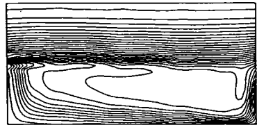
Figura 6.5.90 Izotermele pentru Re = 400 H^* = 0,5 P^* = 2 Pr = 7
