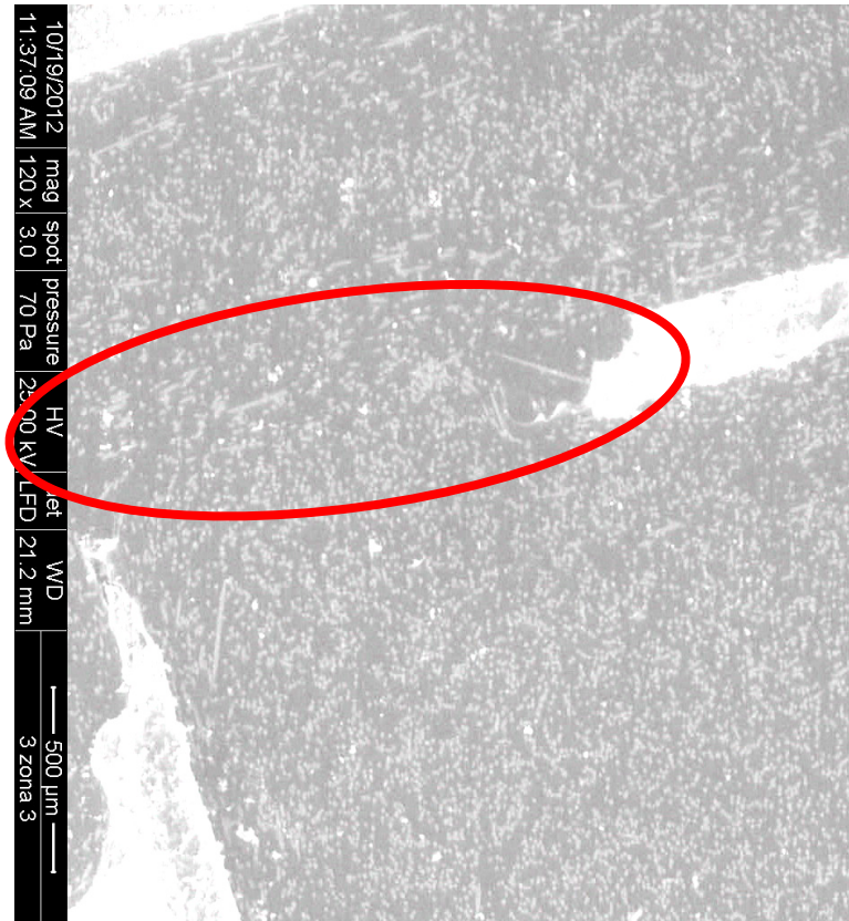
Figura 5.27 Microstructura îmbinare sudată LASER. Marcaj-sudura materialelor
