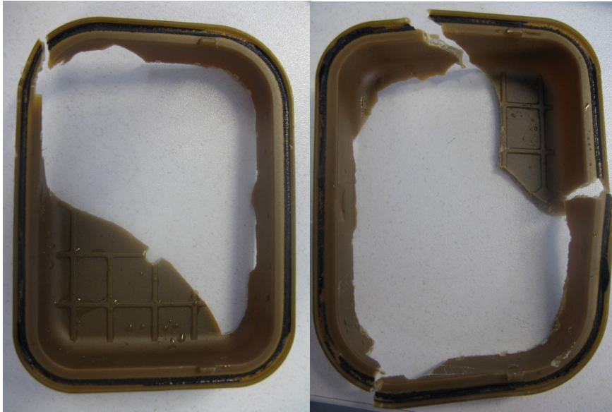
Figura 5.25 Detaliu capac in urma testului de presiune
