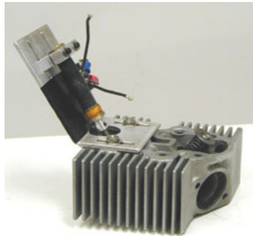
Figura 1.32 „Mușchi” cu elemente din aliaje cu memoria formei
