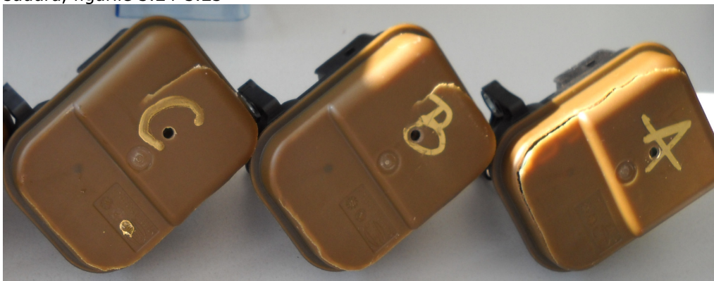
Figura 5.24 Detalii subansamble în urma testului de presiune
