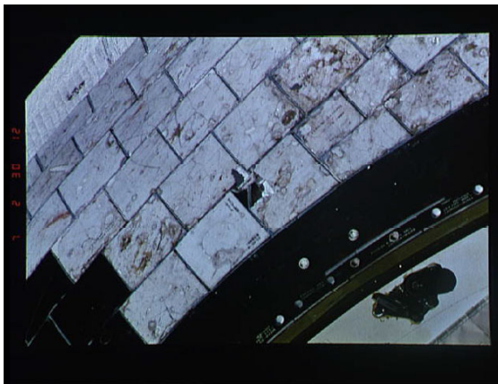
Figura 1.16 Vedere scut termic-naveta Discovery
