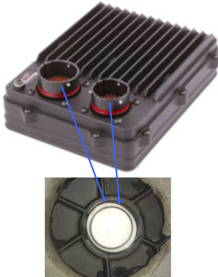
Figura 4.22 Aspect vizual al sudării cu ultrasunete membrana PTFE cu carcasa din PPE
