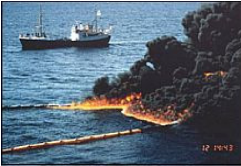
Figura. 1.21 Bariere cu înveliș ceramic
