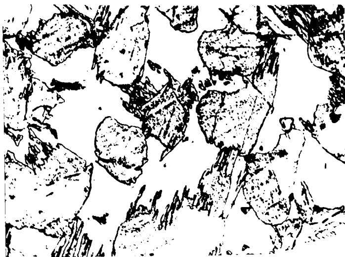
Fig.4.20. Microstructura oțelului T09 la T_v = 1200^\circ\text{C} , (atac HCl, 500x) [87].
