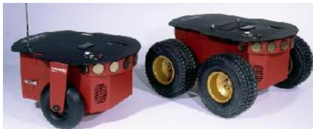
Fig.1.9. Structuri de roboți Pioneer
