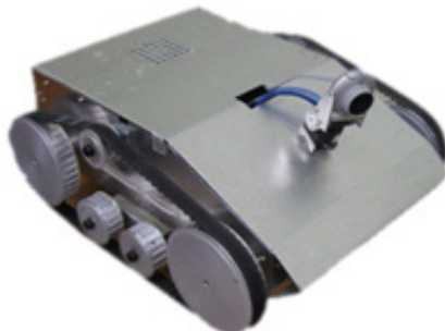
Fig.2.19. Robot în inspecția clădirilor
