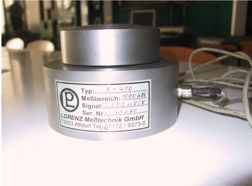
Figura 5.21.b. Celula de forță Lorenz Messtechnik K-450, domeniu de măsurare 0-1000kN
