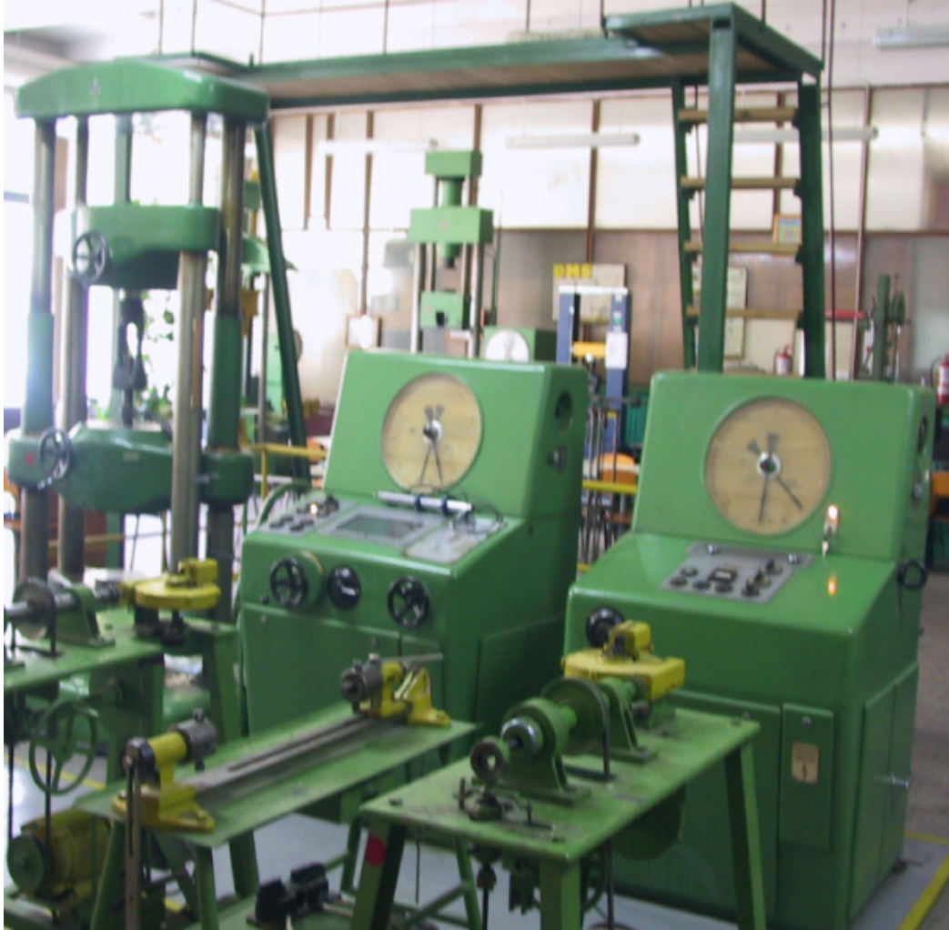
Figura 5.21.a Mașina de încercări de tracțiune-compresiune în regim static sau dinamic, model VEB 1000 KN sarcina maximă, acționare hidraulică
