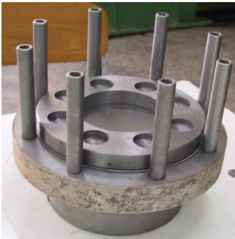
Figura 5.26. Montarea inelului de reținere pe foaia de tablă
