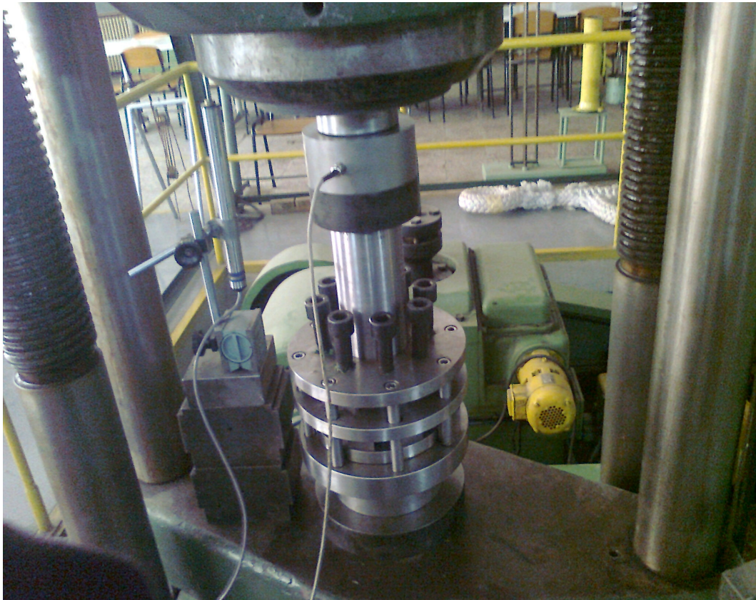
Figura 5.20. Ansamblul experimental compus din dispozitivul de ambutisare și mașina de tracțiune-compresiune
