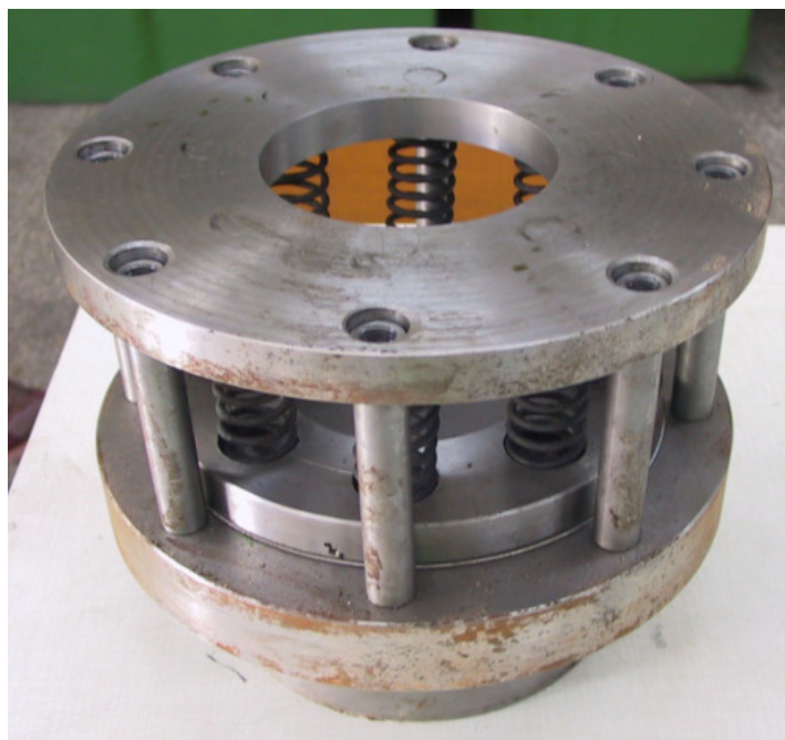
Figura 5.28. Asamblarea plăcii de ghidare pentru tensionarea arcurilor și apăsarea foii de tablă
