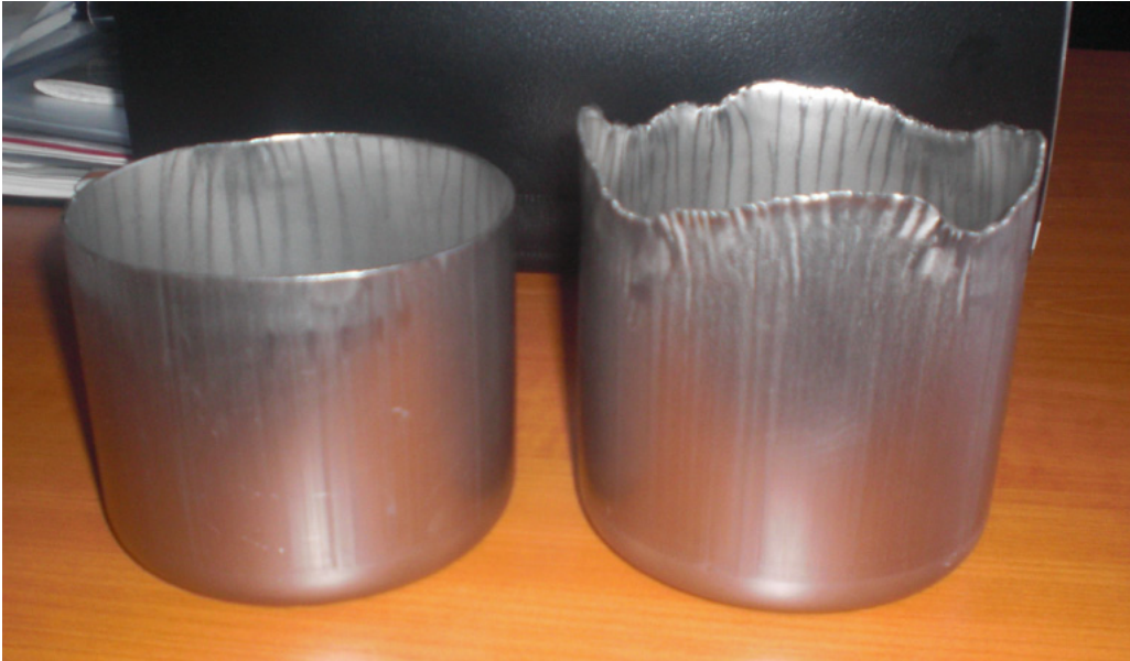
Figura 6.4. Modul de transformare fizică a deformațiilor pe direcțiile X și Y sub formă de festoane sau bavuri (reper debavurat stânga și dreapta reper format cu festoane, bavuri)
