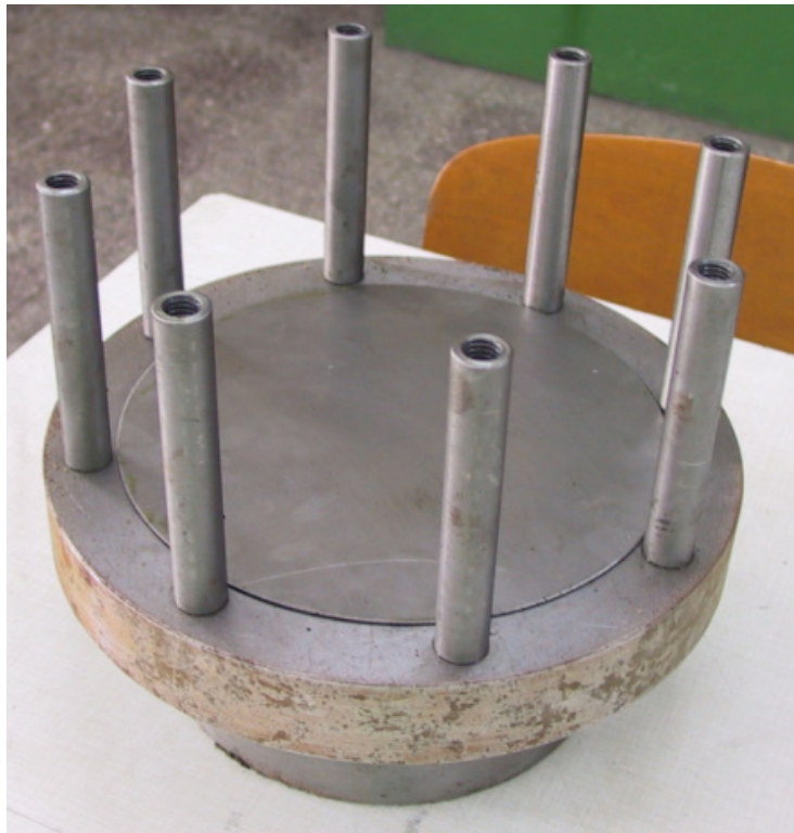
Figura 5.25. Alimentarea dispozitivului de ambutisare cu foaie de tablă pentru experiment
