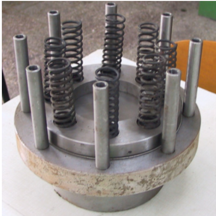
Figura 5.27. Asamblarea elementelor elastice de acțiune, arcurile
