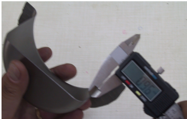
Figura 6.5. Subțiere de 0,04 mm sub raza matriței la adâncimea de 60mm
