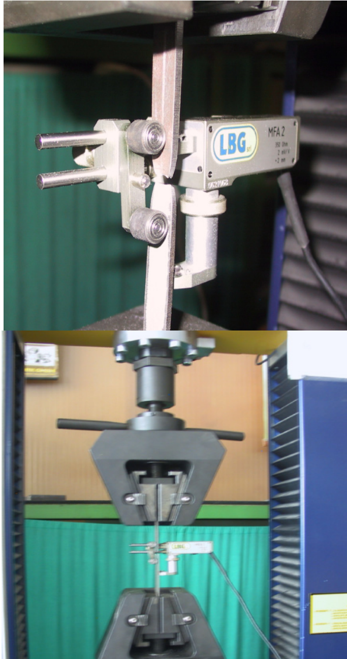
Figura 5.19. Fâșia de tablă cu extensiometru montat între bacurile mașinii de încercat epruvete la tracțiune, LBG TC 100
