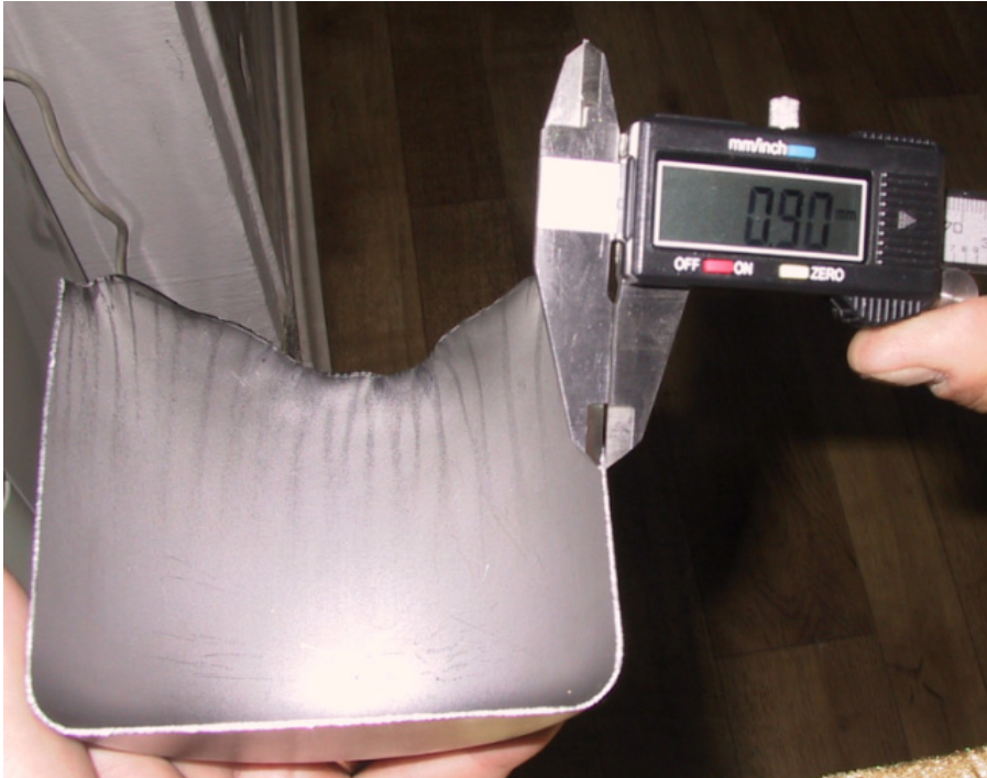
Figura 6.6. Subțiere de 0,1 mm la raza matriței la ambutisarea totală a materialului
