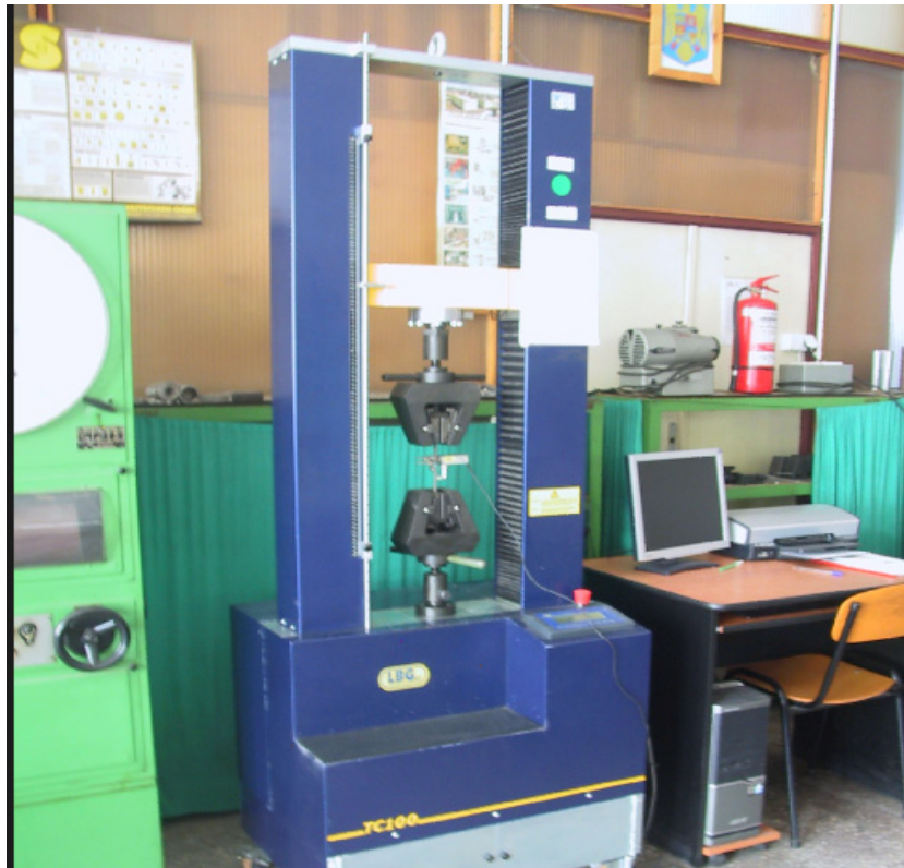
Figura 5.18. Mașina de încercat epruvete la tracțiune LBG TC 100
