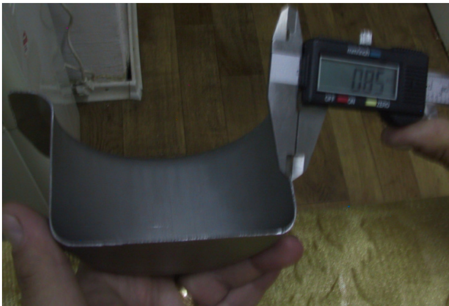
Figura 6.7.a Subțiere de 0,25 mm în zona critică de subțiere deasupra razei poansonului la ambutisarea pe 60 mm adâncime de ambutisare
