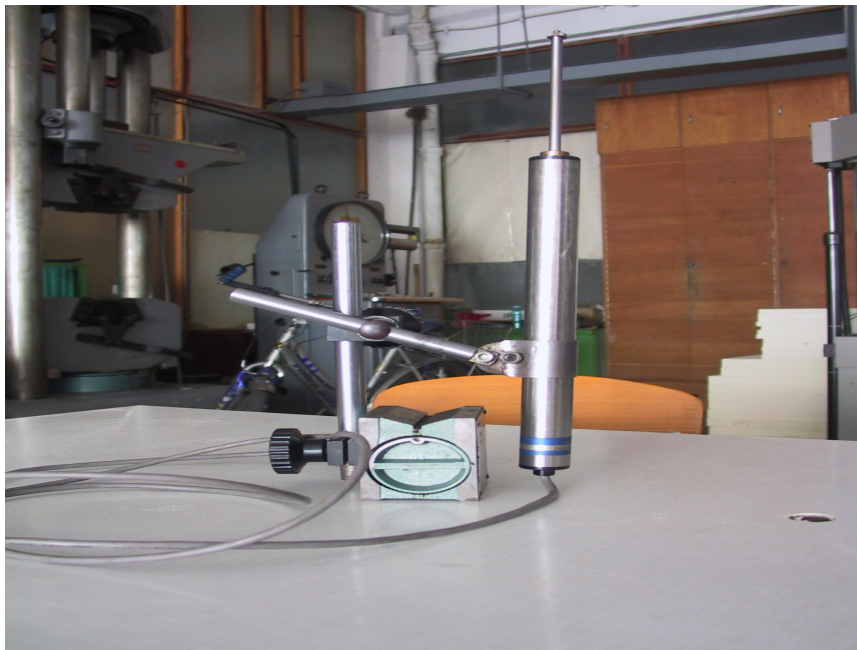
Figura 5.22. Traductorul de adâncime folosit pentru determinarea adâncimii de ambutisare, valoare de măsurare 0-100 mm
