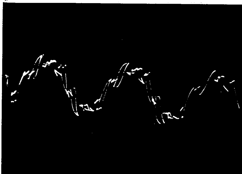
Fig. 5.22. Curentul la \omega = 30\text{Hz} ; a) Forma de undă; b) Spectrul; i_Q = 50
