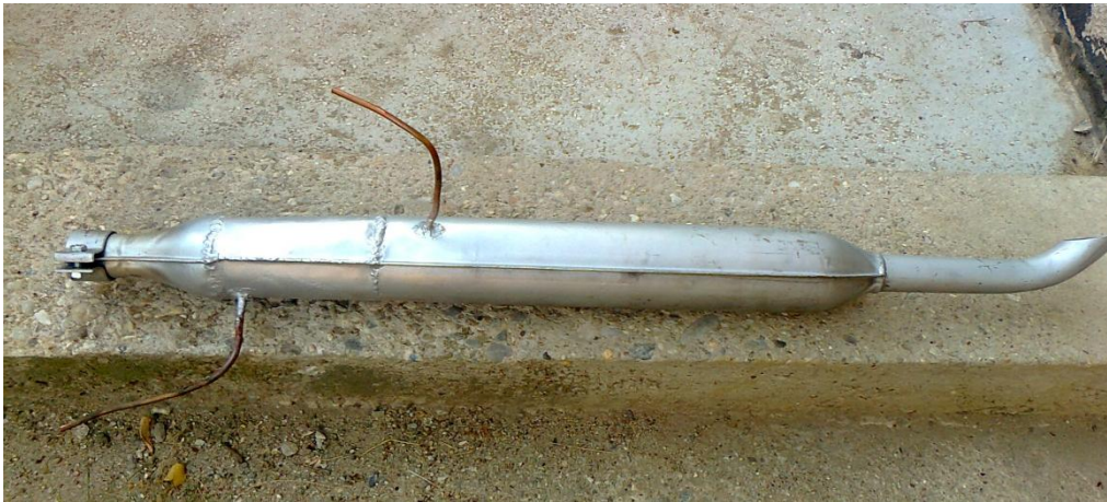
Fig. 4.6. Amortizor de zgomot modificat cu serpentina de preîncălzire a biodieselului
