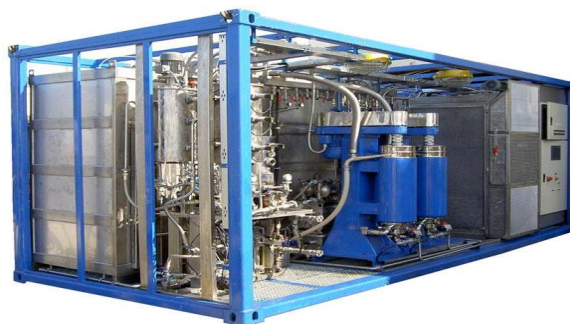
Fig. 1.16. Instalația tehnologică CPU 1000 de producere a biodieselului
