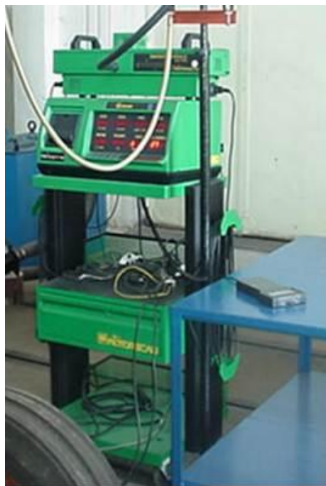
Fig. 5.3. Opacimetru pentru măsurarea opacitatii gazelor de ardere EUROGAS , 8020, SMOKE
