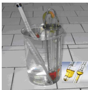
Fig. 3.3. Aparat Ubbelohde pentru utilizat în experimentul pentru determinarea viscozității
