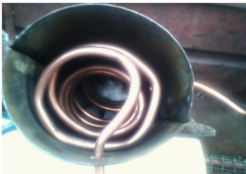
Fig. 4.4. Serpentina de cupru montată secționat în interiorul amortizorului de zgomot
