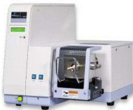
Fig. 3.15. Derivatograful Pyris Diamond TG/DTA utilizat în analizele termice
