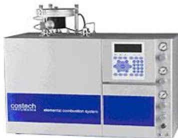
Fig. 3.14. Analizorul elemental COSTECH ECS 4010 – CHNS-O
