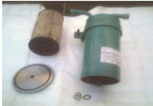
Fig. 4.3. Filtru si carcasa filtru biodiesel
