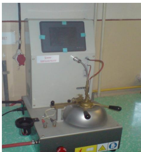
Fig. 3.13. Aparat Pensky-Martens cu cupă închisă utilizat la determinarea punctului de inflamabilitate
