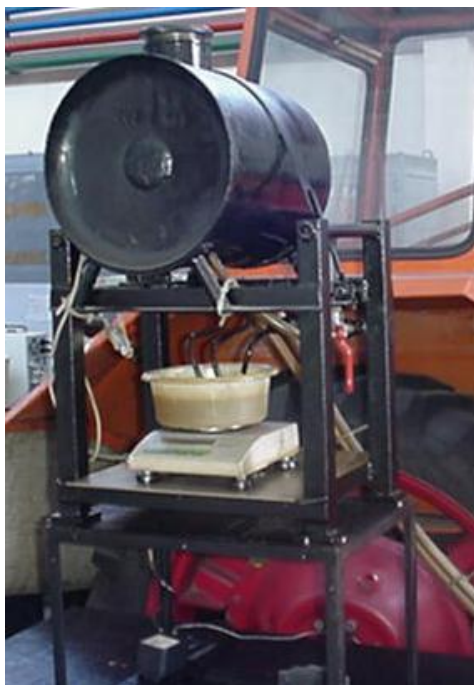
Fig. 5.2. Dispozitiv pentru măsurarea determinarea consumului orar gravimetric combustibil
