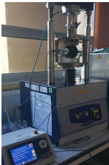
Figura 3.14 – Determinarea sensibilității la apă prin întindere indirectă
