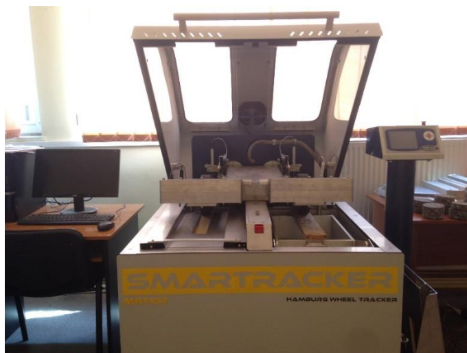
Figura 3.15 – Aparat pentru determinarea adâncimii făgașelor în laborator
