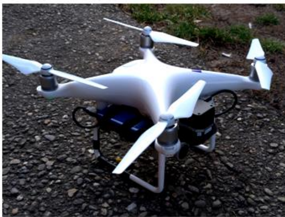
Figura 3.26 – Cameră termică montată la bordul unui vehicul aerian fără pilot
