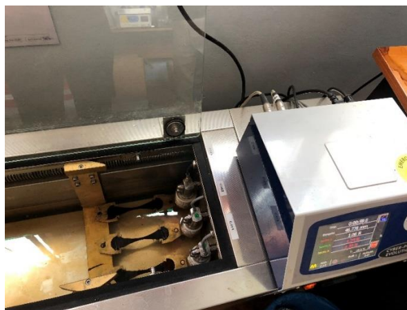
Figura 2.15 – Aparat pentru determinarea ductilității
