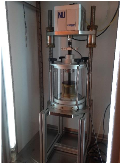
Figura 3.12 - Determinarea fluajului dinamic
