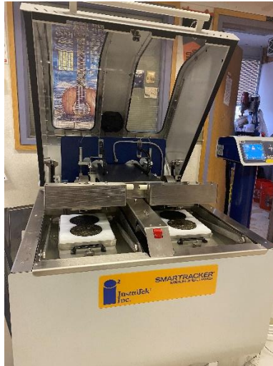
Figura 4.16 – Aparatul Hamburg Wheel-Tracking
