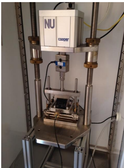
Figura 3.11 - Determinarea modulului de rigiditate prin întindere indirectă
