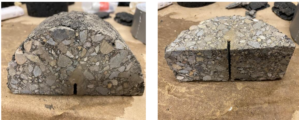
Figura 4.12 – Epruveta pentru încercarea SCB
