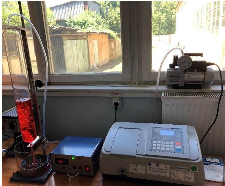
Figura 2.16 – Aparat pentru determinarea adezivității
