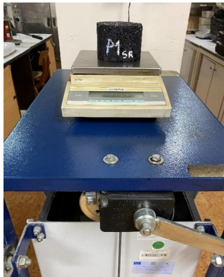
Figura 3.8 - Cântărirea probelor cu balanța electronică
