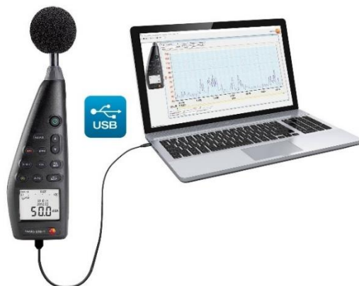
Figura 3.6 Sonometru testo 816-1 și conexiunea sa pentru livrarea datelor măsurate
