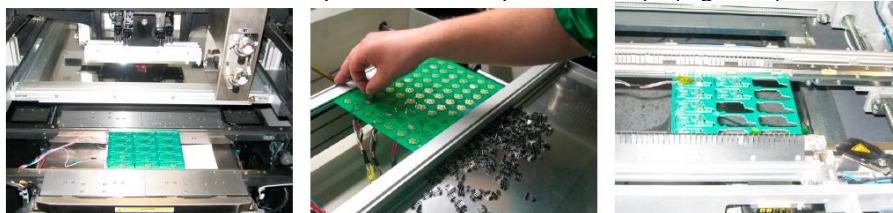
Fig.2.17 Imprimare pastă de lipit, asamblare componente și depanelare PCB (Chvojan, J. and Vaclavik, J. (2018))
