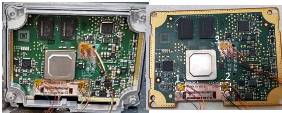
Fig.3.3 Amplasamentul mărcilor tensometrice pe PCB
