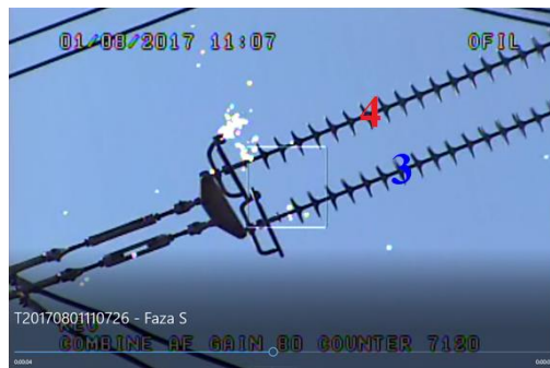
Fig. 6.6.10. Curenții de scurgere la 6 izolatoare compozit de 400 kV măsurati on-line
