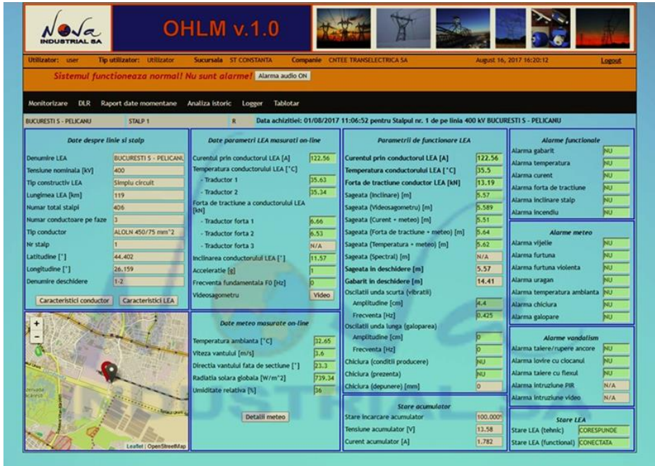
Fig. 6.6.7. Rezultate ale măsurării on-line a parametrilor de funcționare a LEA 400 kV București Sud - Pelicanu folosind sistemul NOVA OHLM
