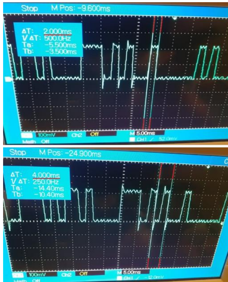
Figura 37. Semnalul digital generat pe baza mesajelor specifice livrate de Aplicația Gateway la o recurență de 2 ms
