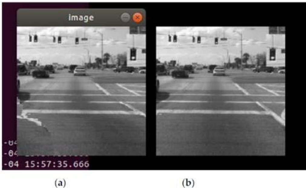
Figurile 26. Comparație între imaginea recepționată (a) și imaginea originală (b) la o recurență de transmisie de 1 ms/valoare a unui pixel. (Faza 2)
