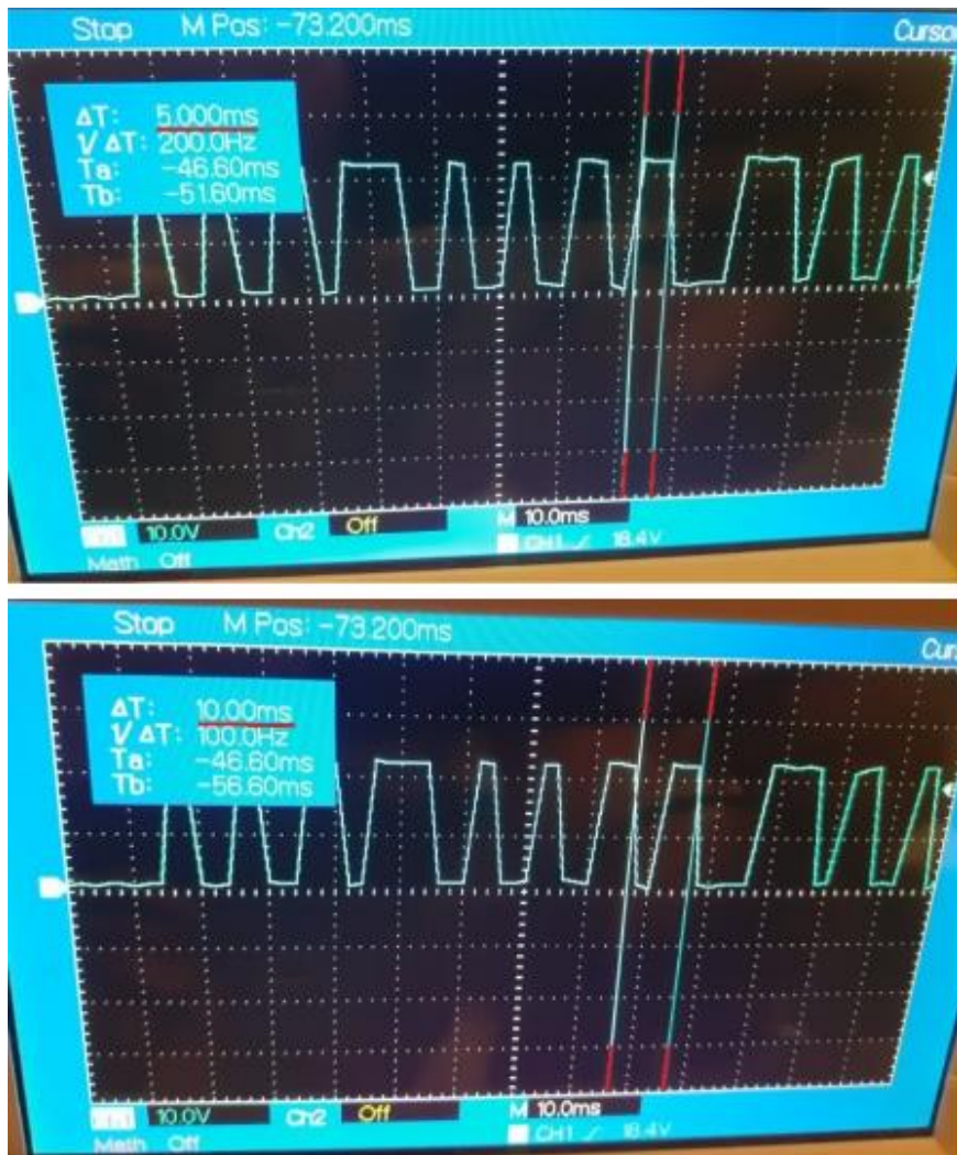
Figura 36. Semnalul digital generat pe baza mesajelor specifice livrate de Aplicația Gateway la o recurență de 5 ms
