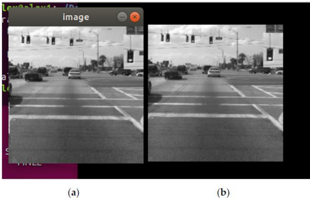
Figurile 27. Comparație între imaginea recepționată (a) și imaginea originală (b) la o recurență de transmisie de 4 ms/valoare a unui pixel. (Faza 2)
