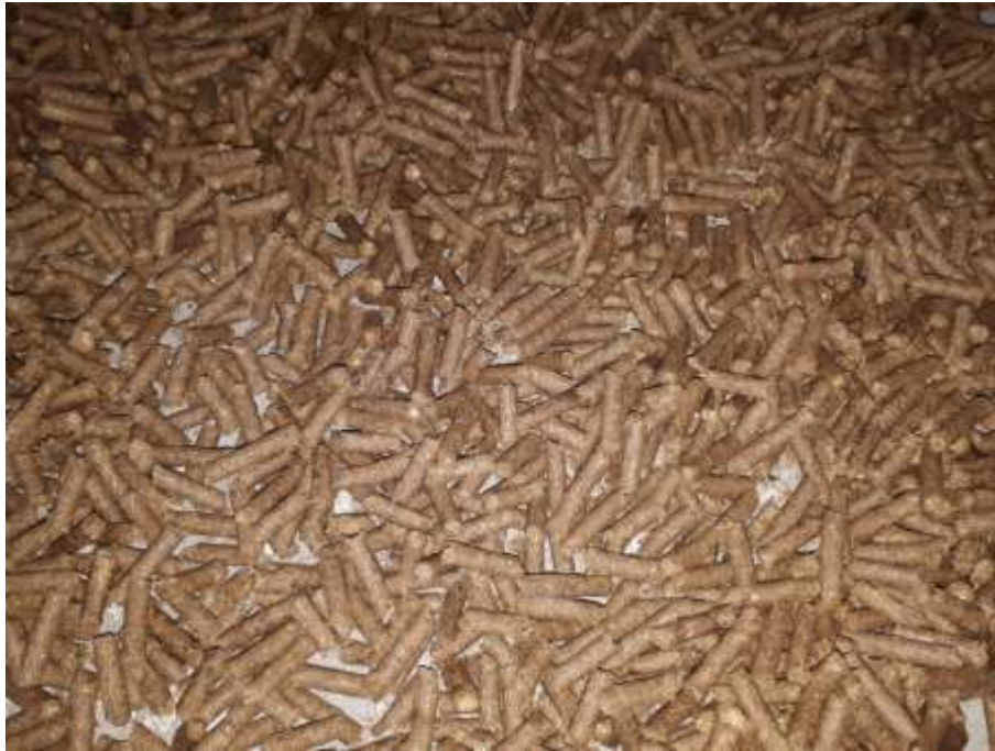
Figura 2.21 Peleți obținuți cu presa de peleți de capacitate mică
