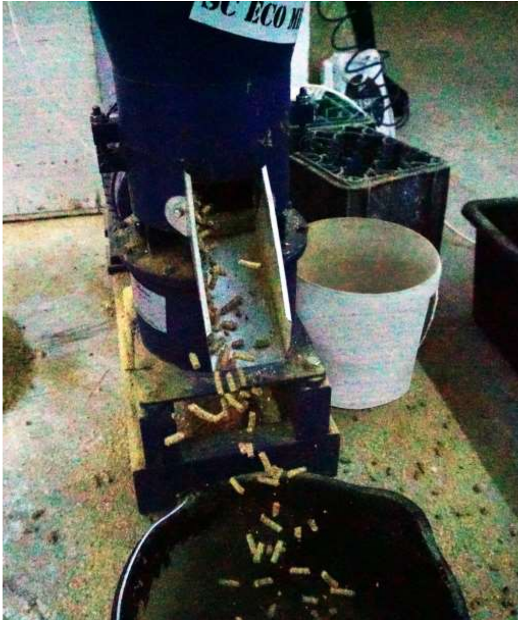
Figura 2.20 Detaliu funcționare presă peleți de capacitate mică
