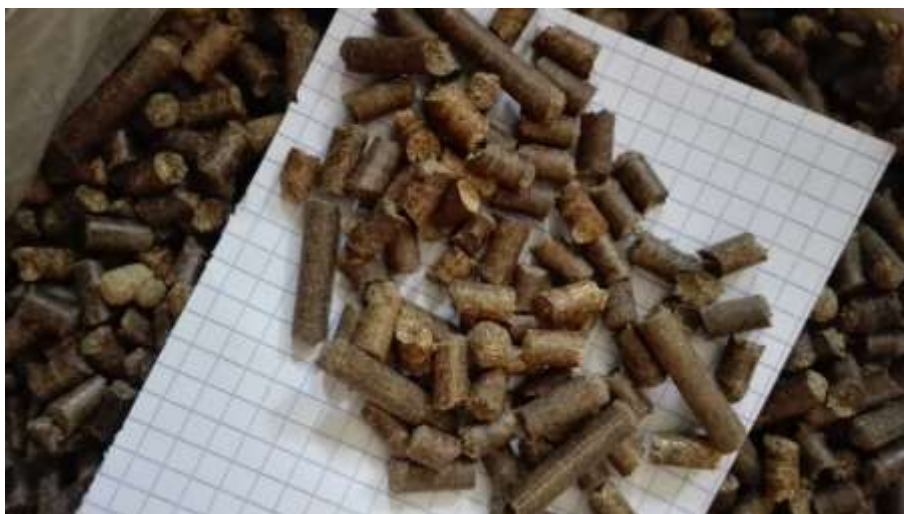
Figura 2.10 Mostră de peleți de paie obținută cu linia de peleți
