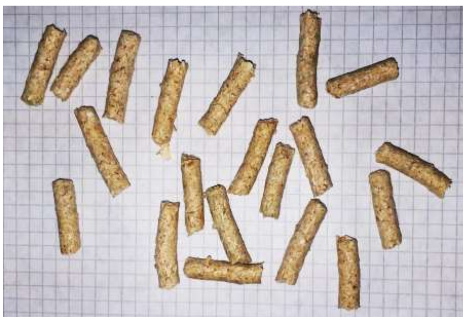
Figura 4.14 Peleți obținuți cu rețeta v08 (40:60:5)
