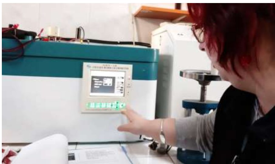
Figura 4.1 Calorimetrul XRY-1B – detaliu de operare
