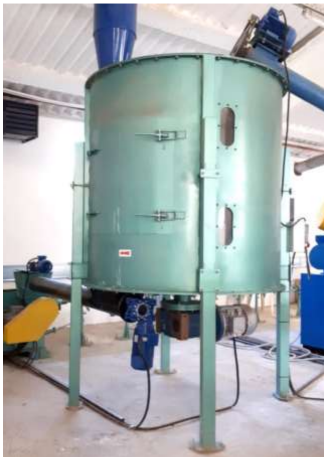
Figura 2.5 Buncărul instalației de uscare
