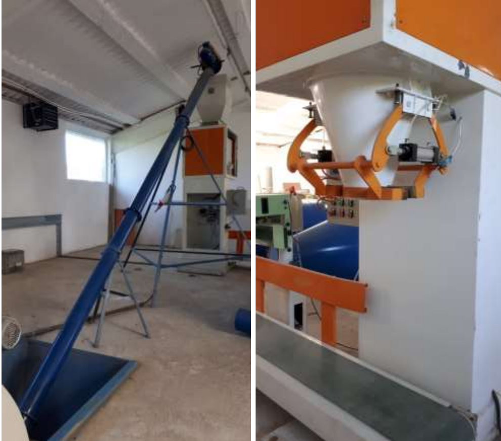
Figura 2.11 Banda transportoare și instalație de ambalare
