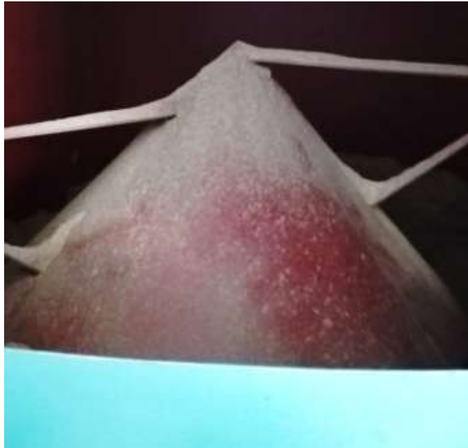
Figura 2.6 Dispozitiv de omogenizare în buncăr
