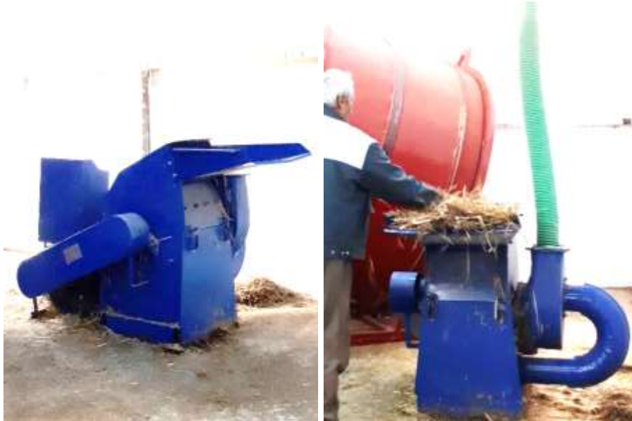
Figura 2.3 Moara cu ciocane – operare în timpul testelor
