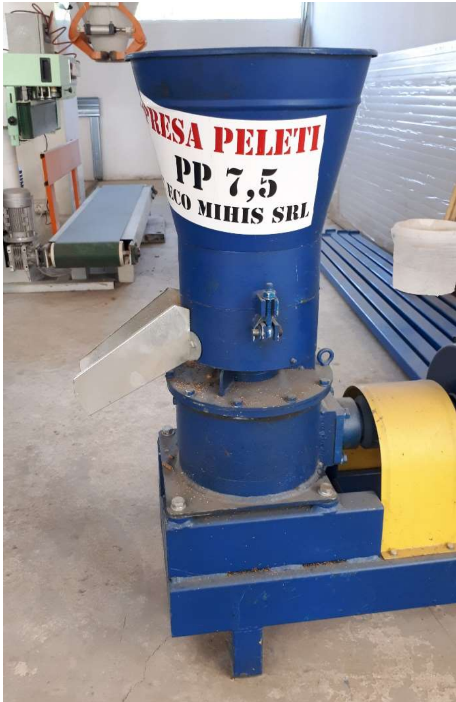
Figura 2.19 Presă peleți cu matriță plană, de capacitate mică
