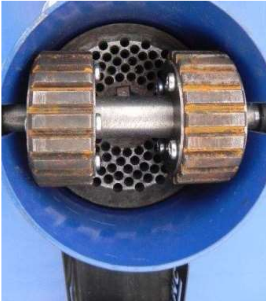
Figura 2.18 Presă de peleți cu matriță plană – detaliu constructiv
