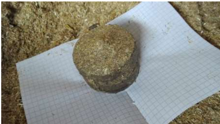
Figura 2.13 Mostră de brichetă de paie obținută cu linia de brichetat
