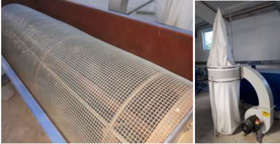
Figura 2.14 Instalație de răcire și cernere
